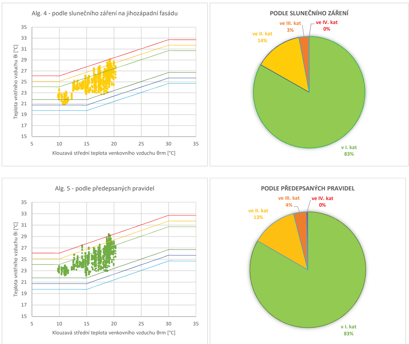
obr. 73 - Dílčí grafy adaptivního modelu algoritmů stínění 3 – s uvažováním zvýšeného větrání
