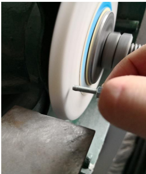
Obr. 3.2 - Zarovnání plochy dříku šroubů
