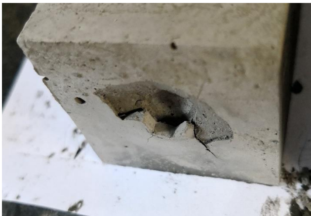
Obr. 3.8 - Vytržení šroubů u mikrosiliky
