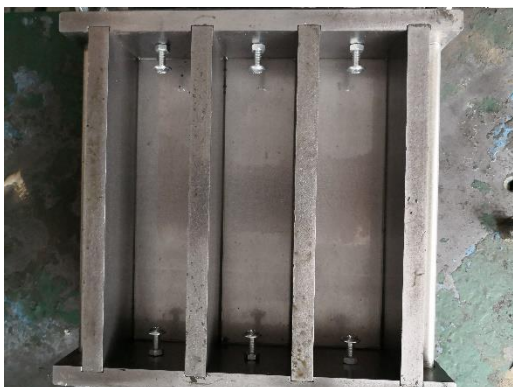
Obr. 3.4 - Forma s osazenými šrouby
