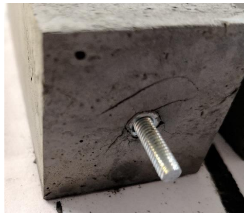
Obr. 3.9 - Uvolnění šroubu popraskáním mikrosiliky
