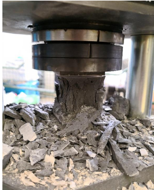
Obr. 3.43 - lis pro zkoušení krychelné pevnosti v tlaku
