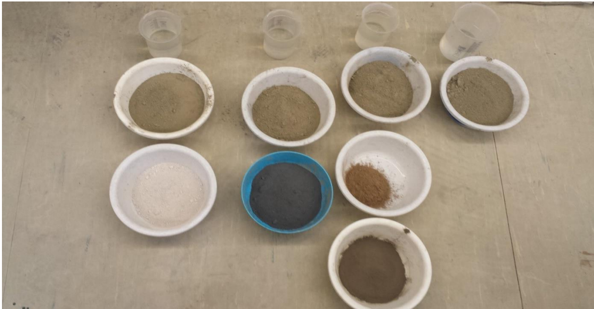
Obr. 3.3 – Navážené složky – metakaolin (vlevo), mikrosilika (druhá zleva), popílek (třetí zleva), referenční vzorek (vpravo)
