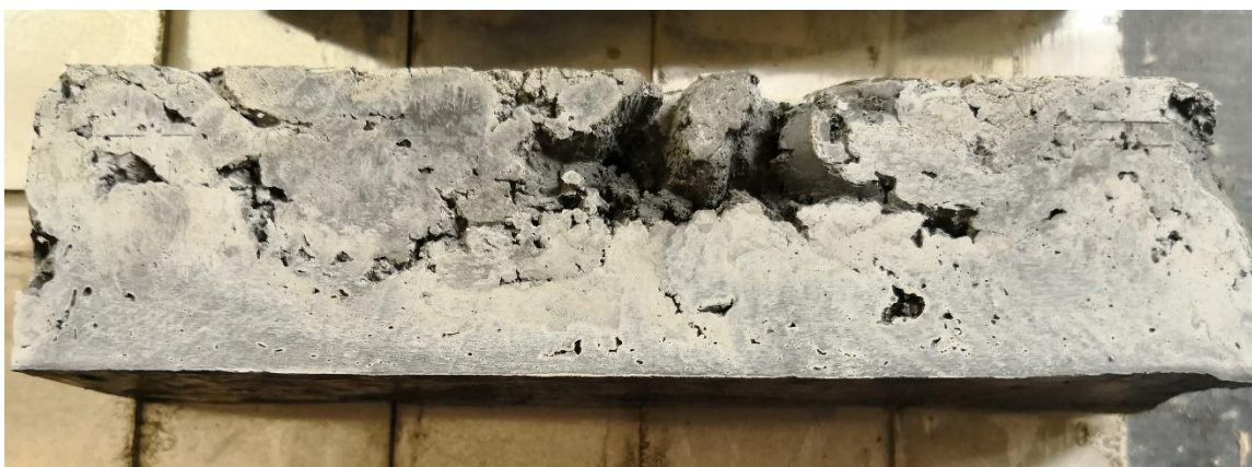
Obr. 3.10 - Nedokonale zvibrovaný vzorek mikrosiliky 50 % po odbednění
