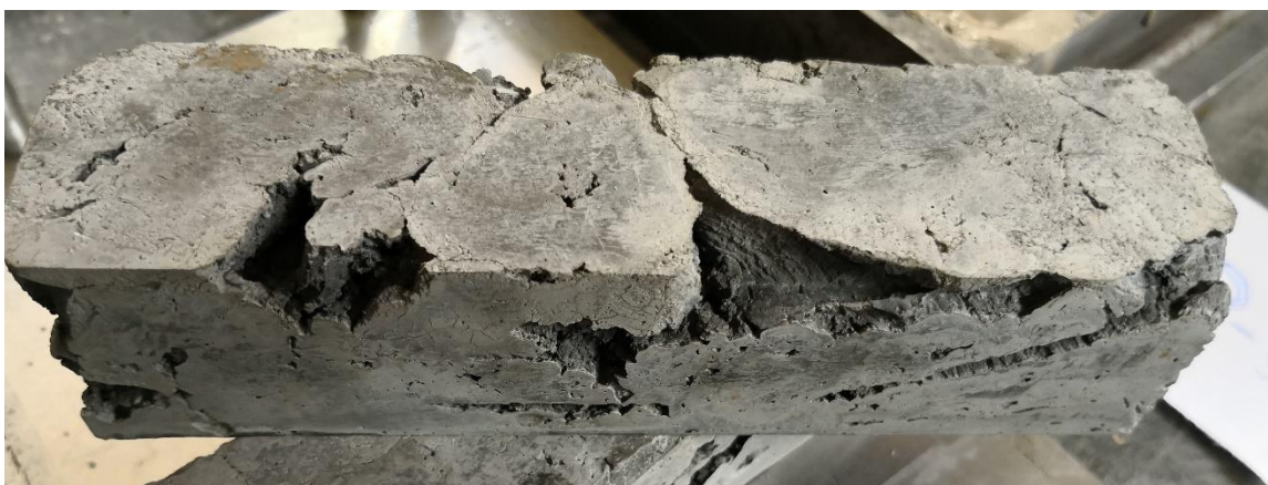
Obr. 3.11 - Nedokonale zvibrovaný vzorek mikrosiliky 50 % po odbednění (2)
