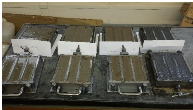
Obr. 3.5 - Čerstvě vybetonované formy
