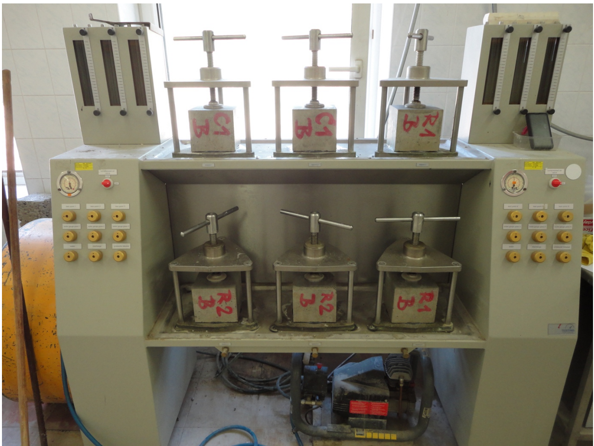
Obr. 104: Připravené vzorky na testování 6.8.2018 nasazené na stoličky zatížené vodním tlakem
