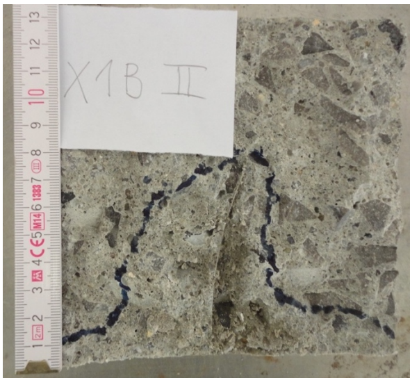
Obr. 115, 116: Průsaky tlakovou vodou vzorku X1B II– vlevo 85 mm, vpravo 85 mm
