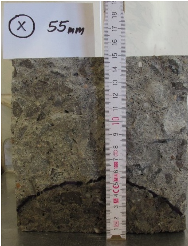
Obr. 70, 71: Průsaky tlakovou vodou obou polovin zkušební krychle XYP I-60 mm
