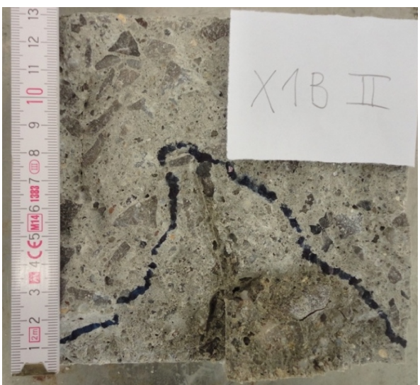
Obr. 115, 116: Průsaky tlakovou vodou vzorku X1B II– vlevo 85 mm, vpravo 85 mm
