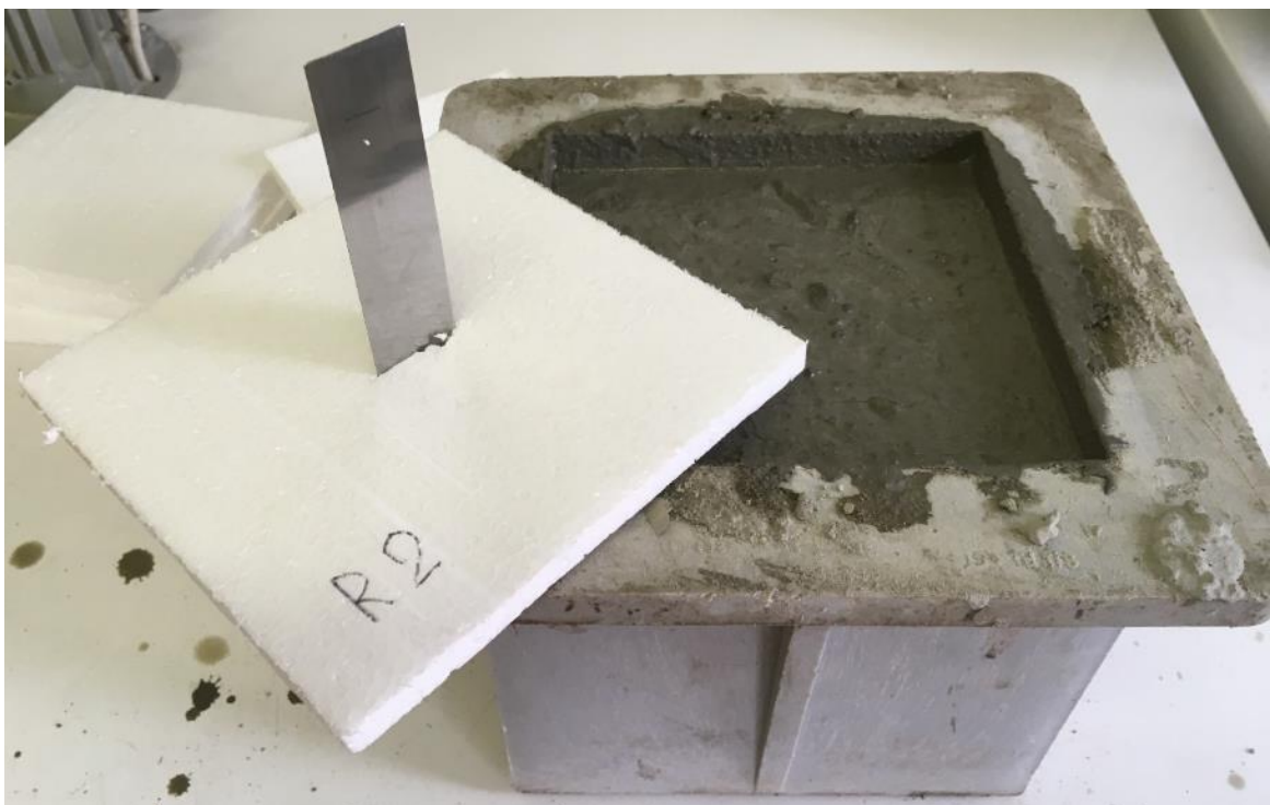
Obr. 52: Detail vzorku připraveného pro osazení spárové měrky
