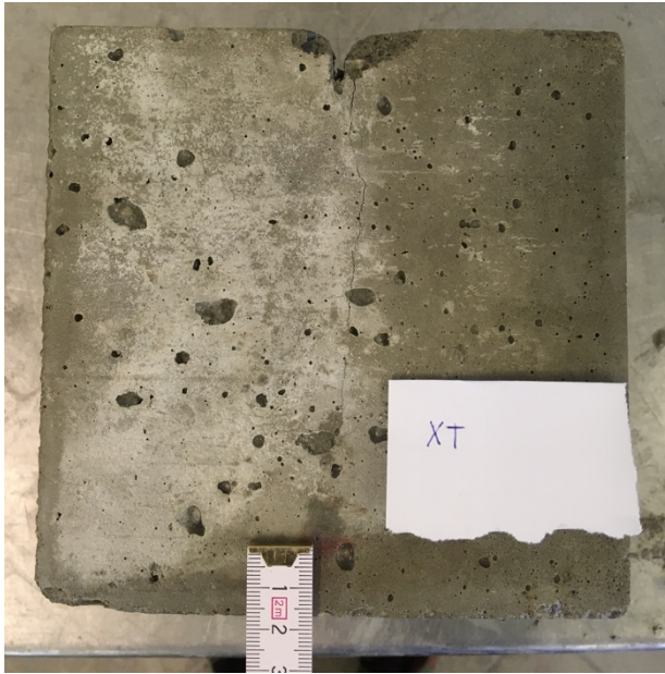
Obr. 166: Zkušební krychle s naměřenou výškou výtoku 16 mm, krychle je ze záměsi XYP
