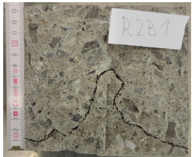
Obr. 109, 110: Průsaky tlakovou vodou vzorku R2B I– vlevo 75 mm, vpravo 80 mm
