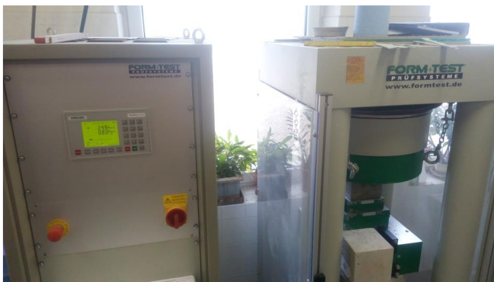
Obr. 64: Pohled na zatěžovací lis, vlevo ovládací panel s naměřenými hodnotami, vpravo zatěžovací lis s vloženým betonovým vzorkem
