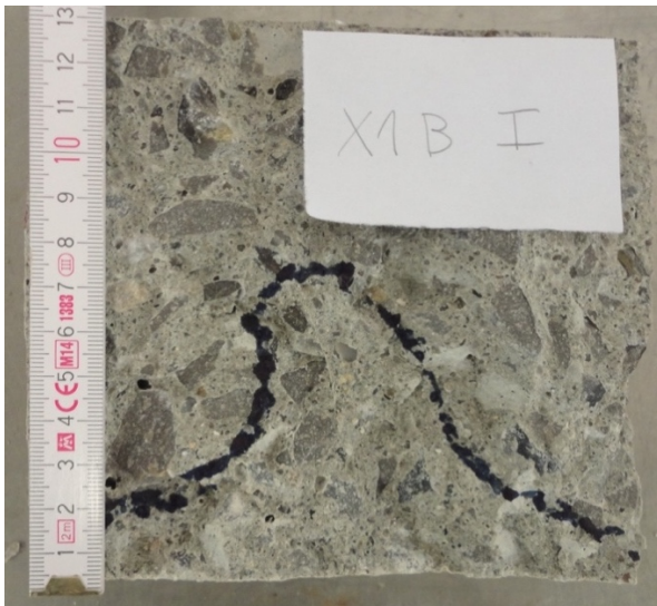
Obr. 113, 114: Průsaky tlakovou vodou vzorku X1B I– vlevo 75 mm, vpravo 85 mm
