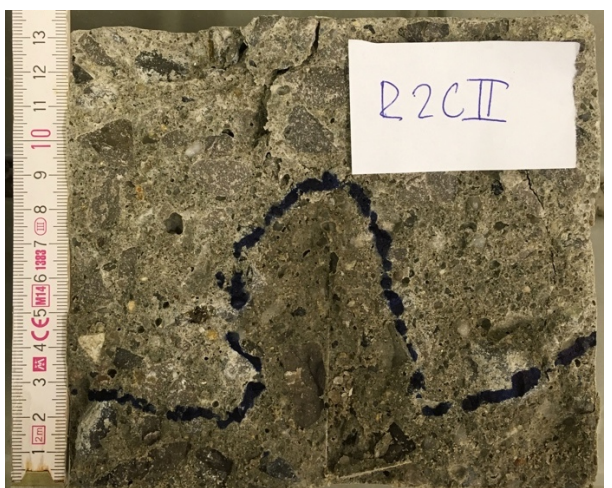
Obr. 135, 136: Průsaky tlakovou vodou vzorku R2C II– vlevo 85 mm, vpravo 90 mm
