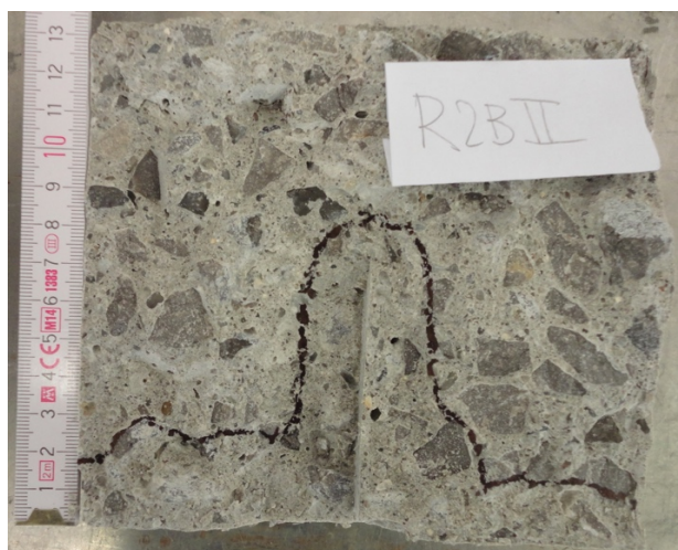
Obr. 111, 112: Průsaky tlakovou vodou vzorku R2B II– vlevo 80 mm, vpravo 85 mm
