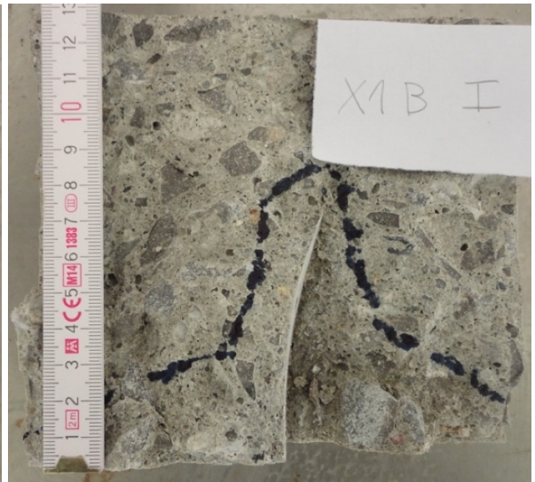
Obr. 113, 114: Průsaky tlakovou vodou vzorku X1B I– vlevo 75 mm, vpravo 85 mm
