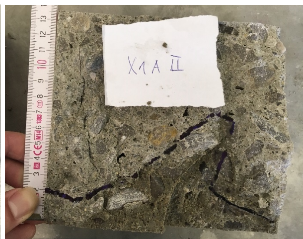
Obr. 88, 89: Průsaky tlakovou vodou vzorku X1A II– vlevo 70 mm, vpravo 75 mm. Na obou fotografiích lze vidět, že zasouvání spárové měřky do betonu nešlo vždy snadno. V tomto případě je zřejmá kolize s větším zrnem kameniva, na experiment tato situace však vliv nemá
