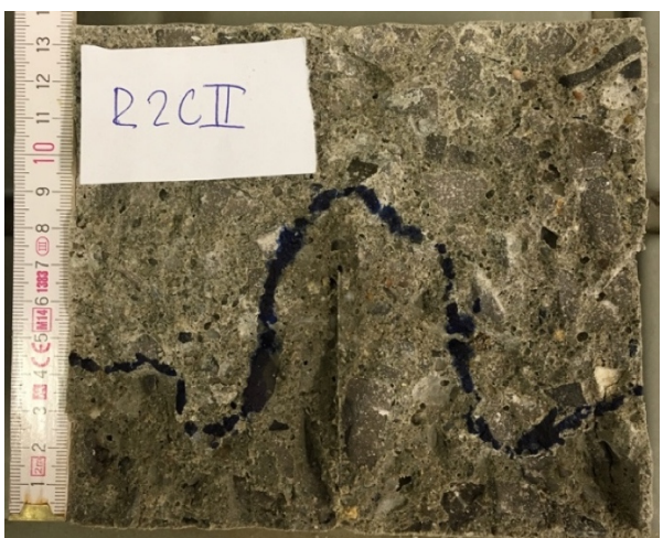
Obr. 135, 136: Průsaky tlakovou vodou vzorku R2C II– vlevo 85 mm, vpravo 90 mm
