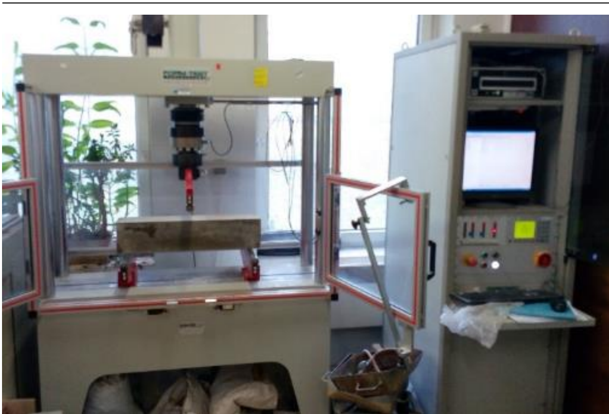
Obr. 44: Zatěžovací stroj pro testování prvků namáhaných ohybem
