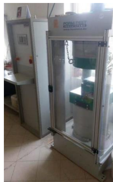
Obr. 45,46: Vlevo použité plastové formy, vpravo přístroj použitý pro zkoušky pevnosti v tlaku
