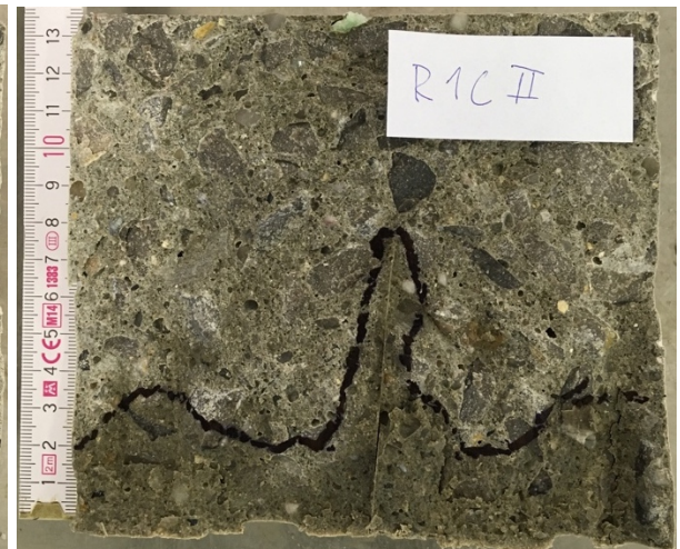
Obr. 131, 132: Průsaky tlakovou vodou vzorku R1C II– vlevo 75 mm, vpravo 75 mm
