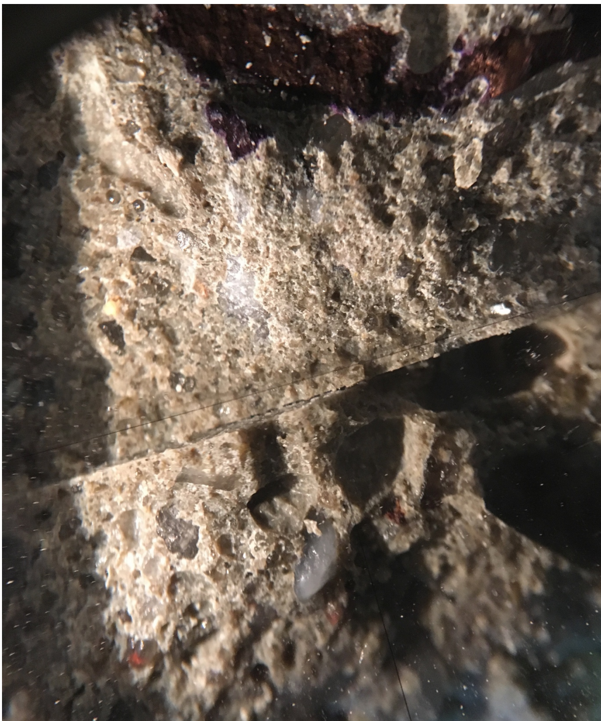
Obr. 158: Fotografie nezarostlé spáry na vzorku RIC II zaznamenaná díky lupě s desetinásobným zvětšením.
