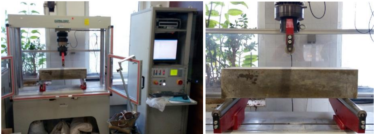
Obr. 27, 28: Vlevo stroj pro zatížení trámců ohybem s přidavnou pracovní stanicí, vpravo uložený vyztužený zkušební trámec před zahájením zkoušky tříbodovým ohybem
