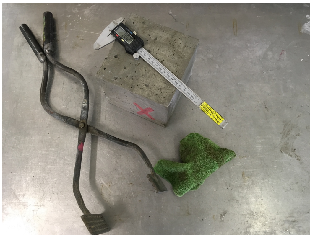
Obr. 61: Pomůcky pro měření objemové hmotnosti ztvrdlého betonu, hadřík pro otření povrchu zkušební krychle od povrchové vody, digitální posuvné měřítko, pro ověření přesnosti měřeného vzorku a kleště pro manipulaci se vzorky
