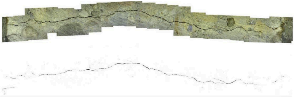
Obr. 5: Panoramatický snímek horní trhliny a její černé pixely (před čištěním)
