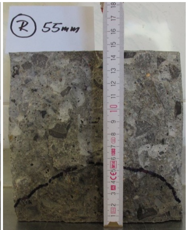
Obr. 66, 67: Průsaky tlakovou vodou obou polovin zkušební krychle REF I–55 mm
