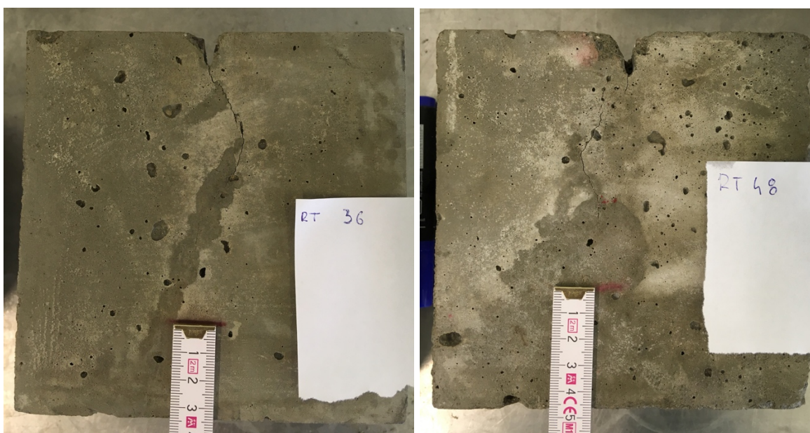
Obr. 164, 165: Vlevo zkušební krychle s naměřenou výškou výtoku 36 mm, vpravo zkušební krychle s naměřenou výškou výtoku 48 mm, obě krychle jsou ze záměsi REF
