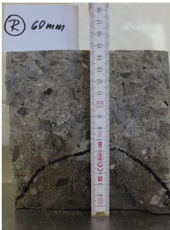
Obr. 68, 69: Průsaky tlakovou vodou obou polovin zkušební krychle REF II – 60 mm
