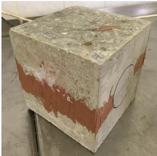
Obr. 36, 37: Vlevo zajišťování trhliny tmelem, vpravo krychle zajištěná tmelem po obvodě
