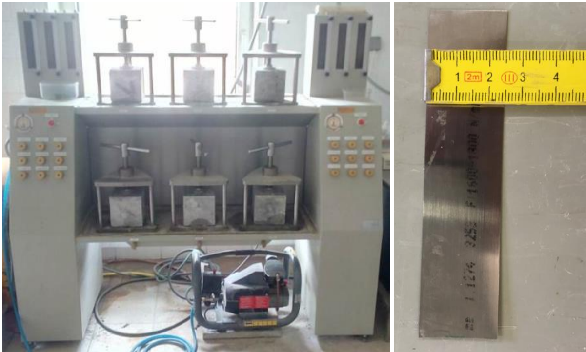
Obr. 40, 41: Vlevo zkušební stolice pro zatížení hydrostatickým tlakem, vpravo spárová měřka šířky 25 mm
