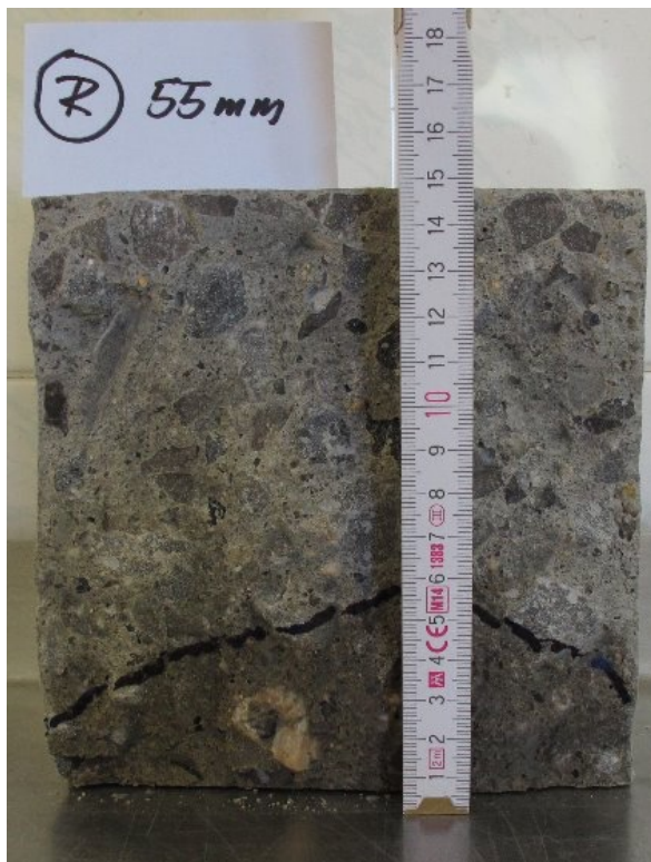
Obr. 66, 67: Průsaky tlakovou vodou obou polovin zkušební krychle REF I–55 mm
