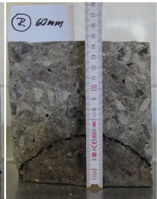
Obr. 68, 69: Průsaky tlakovou vodou obou polovin zkušební krychle REF II – 60 mm
