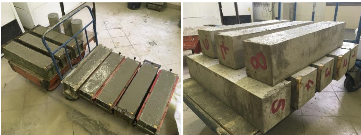
Obr. 24, 25: Vlevo formy se zabetonovanou prutovou výztuží, vpravo odformované zkušební trávce
