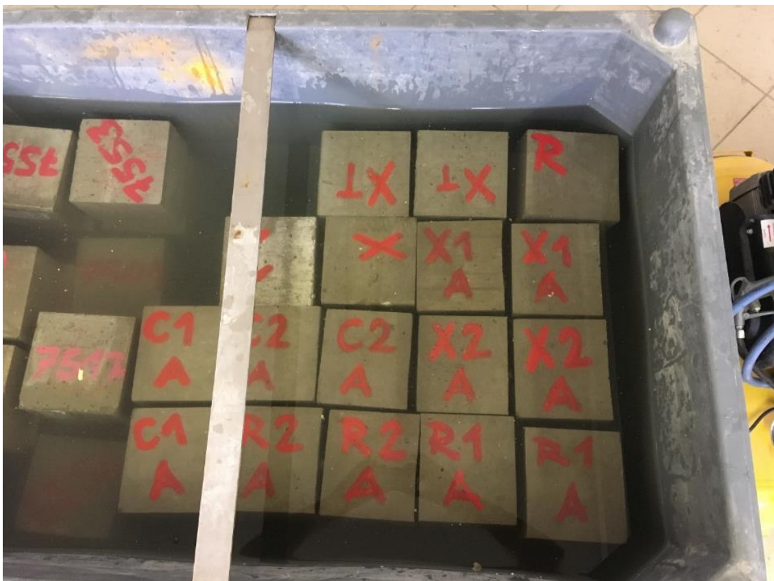
Obr. 55: Betonové krychle uložené ve vodní lázni
