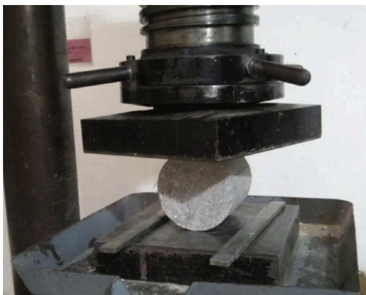
Obr. 1: Proces tvorby trhliny na betonovém prvku
