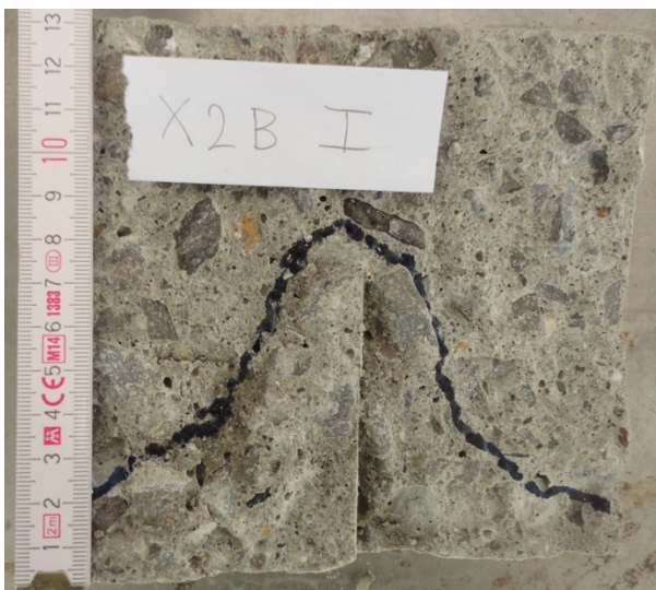
Obr. 117, 118: Průsaky tlakovou vodou vzorku X2B I– vlevo 85 mm, vpravo 85 mm
