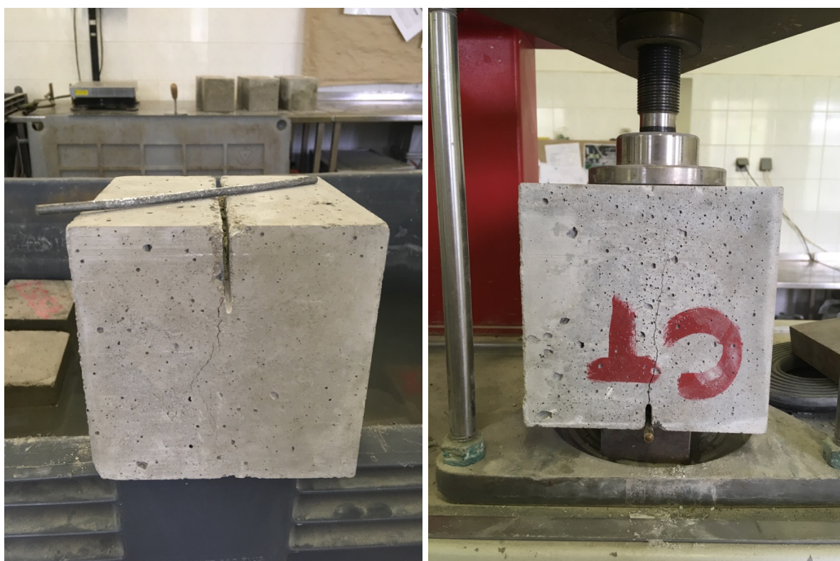
Obr. 162, 163: Vlevo zkušební krychle po zatížení v lisu, vpravo jemné ruční přitěžování na stolici pro zkoušku průsaku pro vznik požadované šířky trhliny
