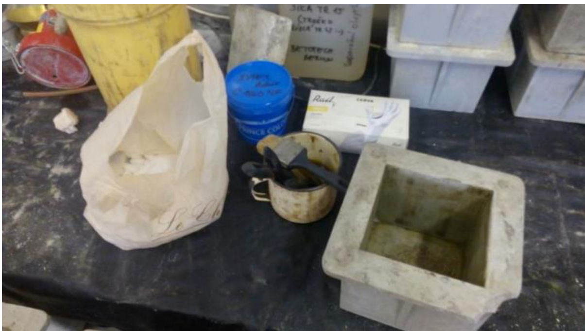
Obr. 49: Příprava forem betonových vzorků – zleva pěnové ucpávky do otvoru ve formě, odbedňovací prostředek, plastová forma pro normovou krychli o hraně 150 mm
