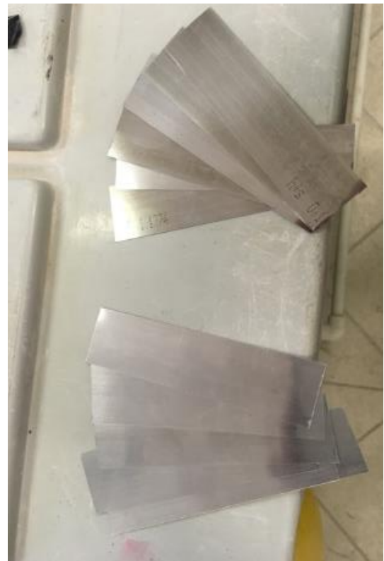
Obr. 50, 51: Vlevo plnění formy uložené na vibrační desce, vpravo spárové měrky přesných rozměrů připravené pro zasunutí do betonu
