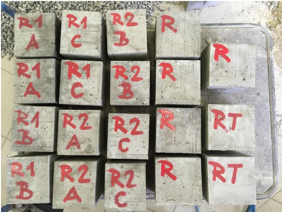
Obr. 54: Odformované betonové krychle připravené pro uložení do vodní lázně na 28 dní
