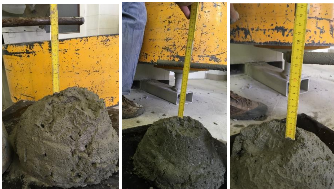
Obr. 58, 59, 60: Sednutí jednotlivých záměsí – vlevo REF – 150 mm, uprostřed XYP – 150 mm, vpravo CEM – 125 mm
