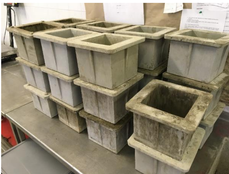
Obr. 45,46: Vlevo použité plastové formy, vpravo přístroj použitý pro zkoušky pevnosti v tlaku
