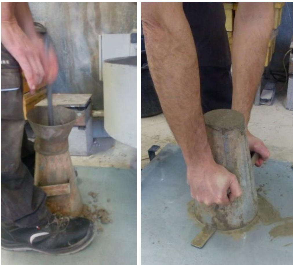
Obr. 56, 57: Vlevo hutnění betonu ukládaného do formy pro zkoušku sednutí kužele, vpravo plná forma před zvednutím
