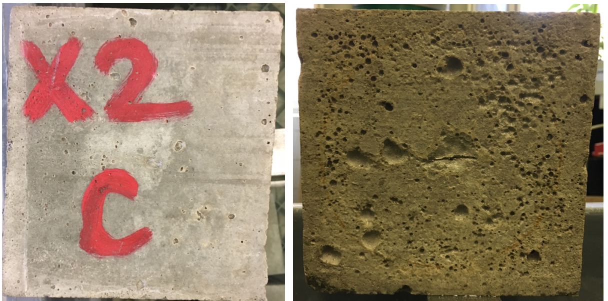
Obr. 145, 146: Vlevo označení vzorku, který nemohl být jako jediný otestován zatížením vodním tlakem kvůli špatně upravenému povrchu, který měl být vodním tlakem zatížen. Vpravo je vidět detail zatěžované strany.
