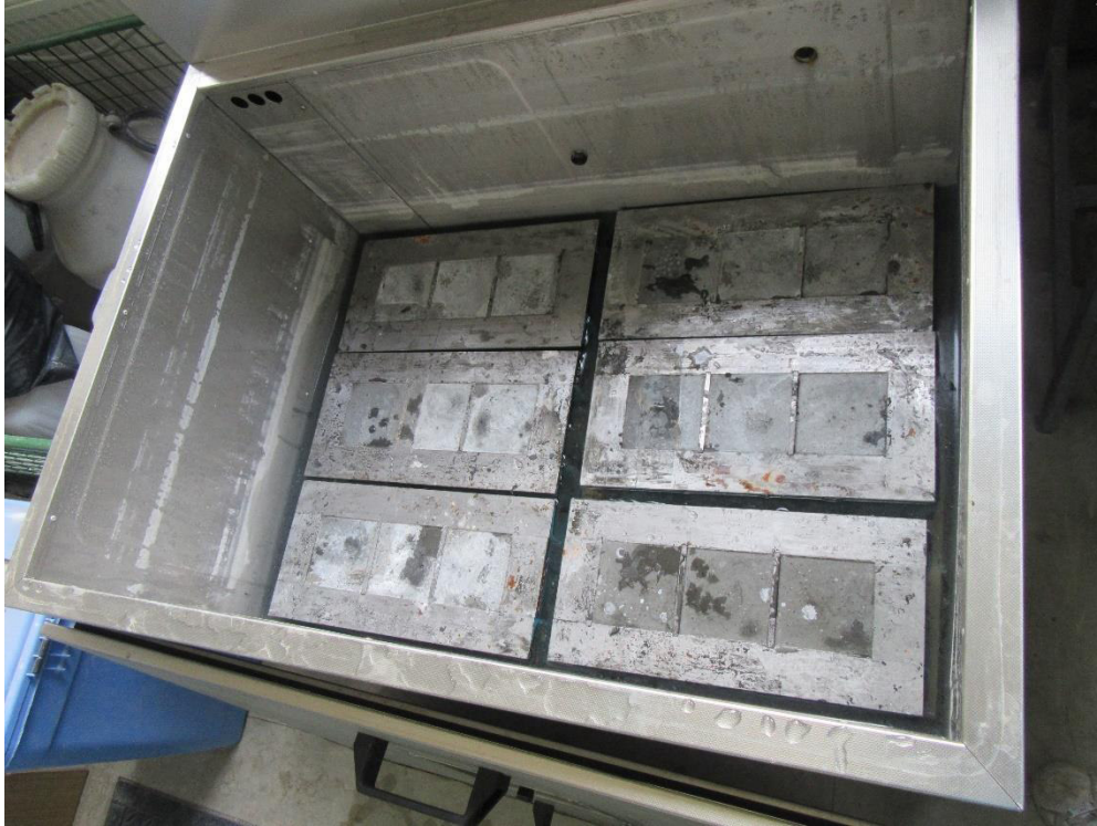
Obr. 23 umístění neodbedněných vzorků v proteplovací komoře
