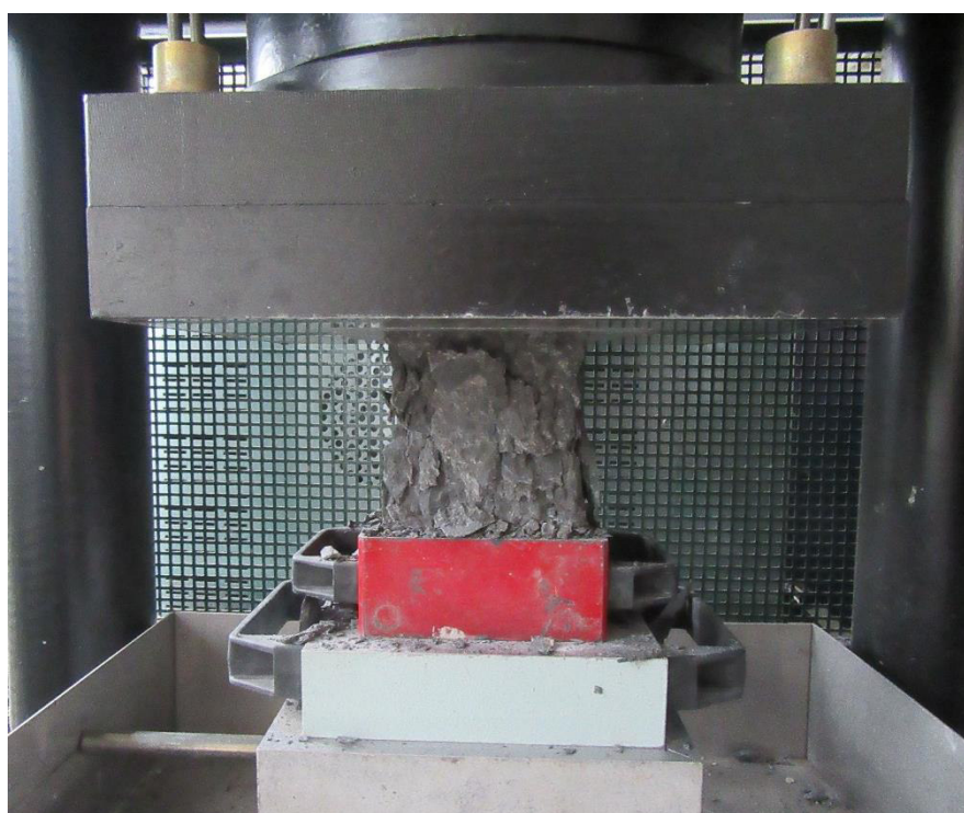
Obr. 24 porušený vzorek – zkouška pevnosti v tlaku
