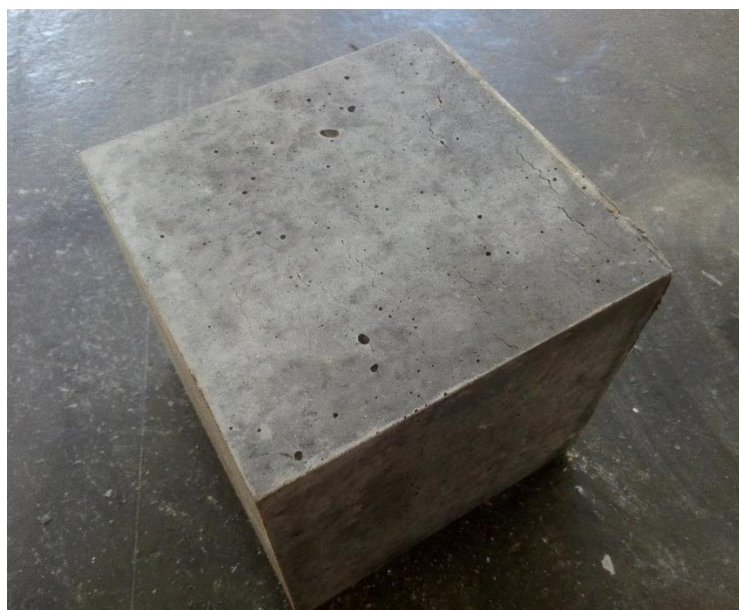
Obr. 34 trhliny v betonu ošetřovaném při teplotě 80 °C
