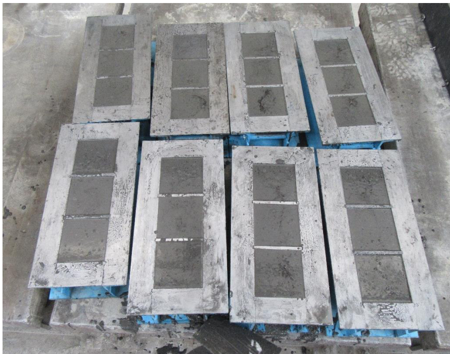
Obr. 20 vybetonované zhuštěné vzorky
