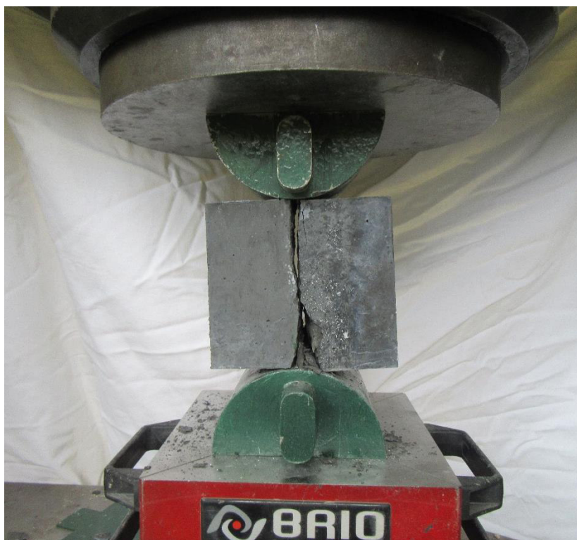
Obr. 25 porušený vzorek – zkouška pevnosti v příčném tahu
