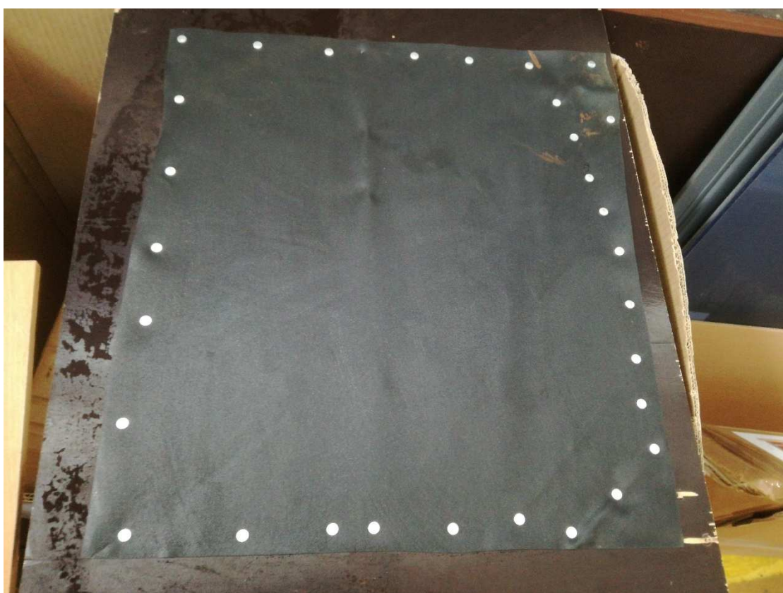
Obr. 122 Napnutá fólie připevněná pomocí kancelářských špendlíků k dřevěné desce
