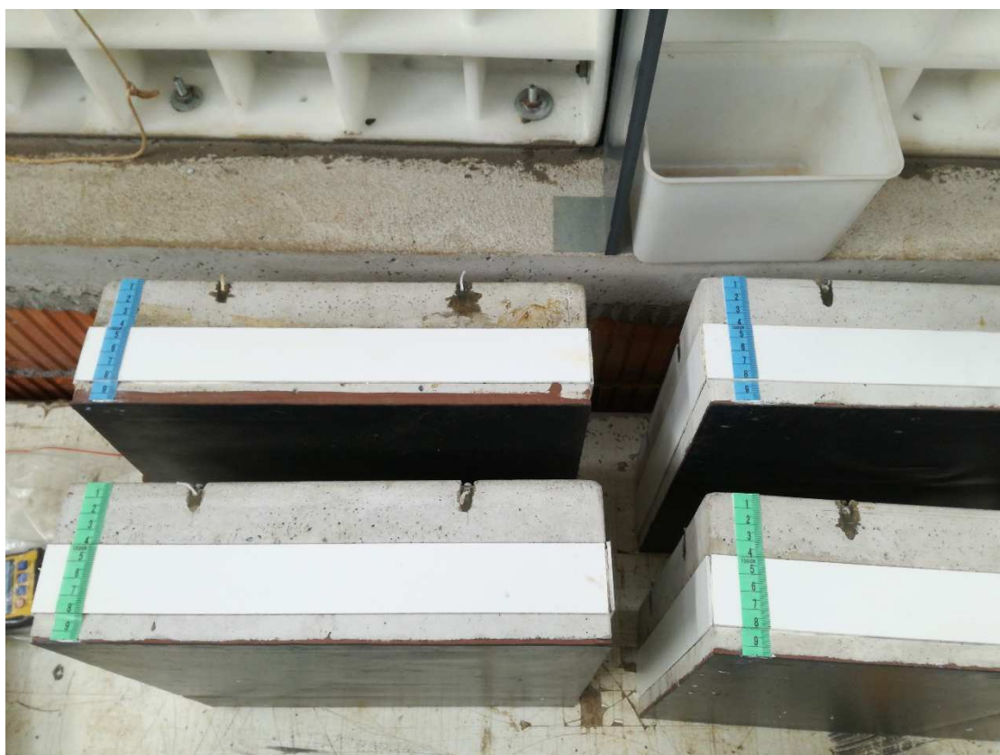
Obr. 127 Plovoucí zkušební prvek
