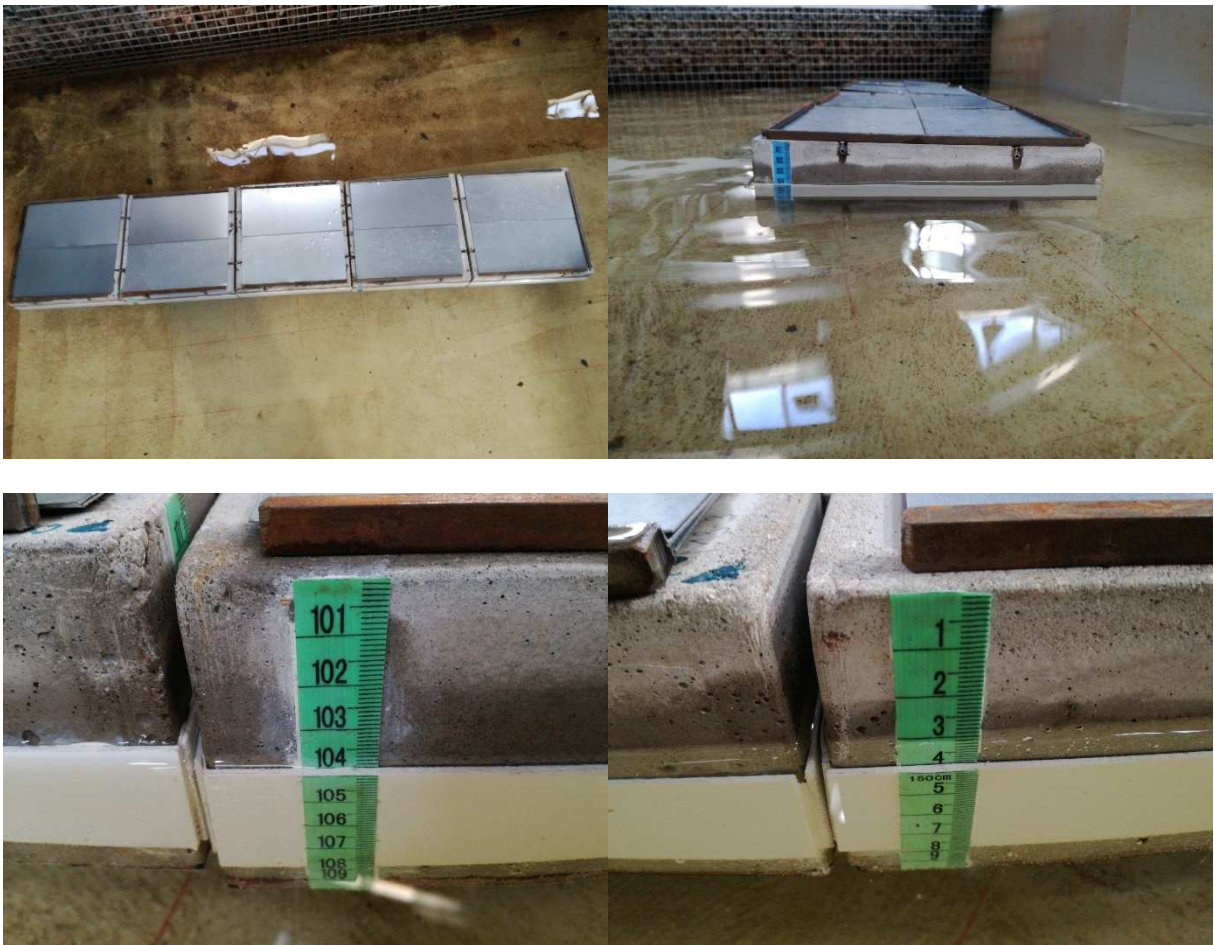
Obr. 161 Fotografie skupiny zkušebních prvků při zatěžovacím stavu C6
