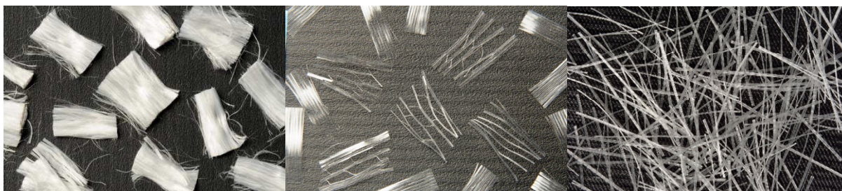
Obr. 63 Jednotlivé třídy polymerových vláken, zleva: třída Ia, třída Ib, třída II – převzato z webu www.abcpolymerindustries.com [45]
