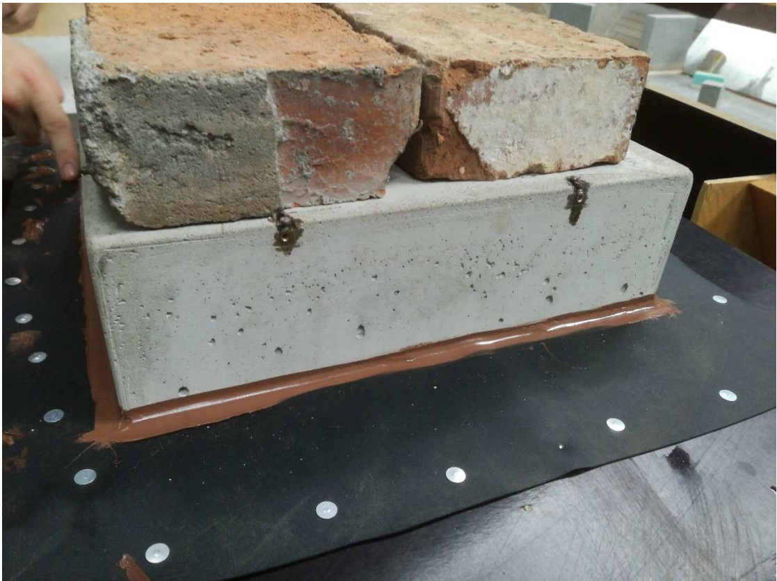
Obr. 124 Přilepený a zatížený zkušební vzorek k fólii
