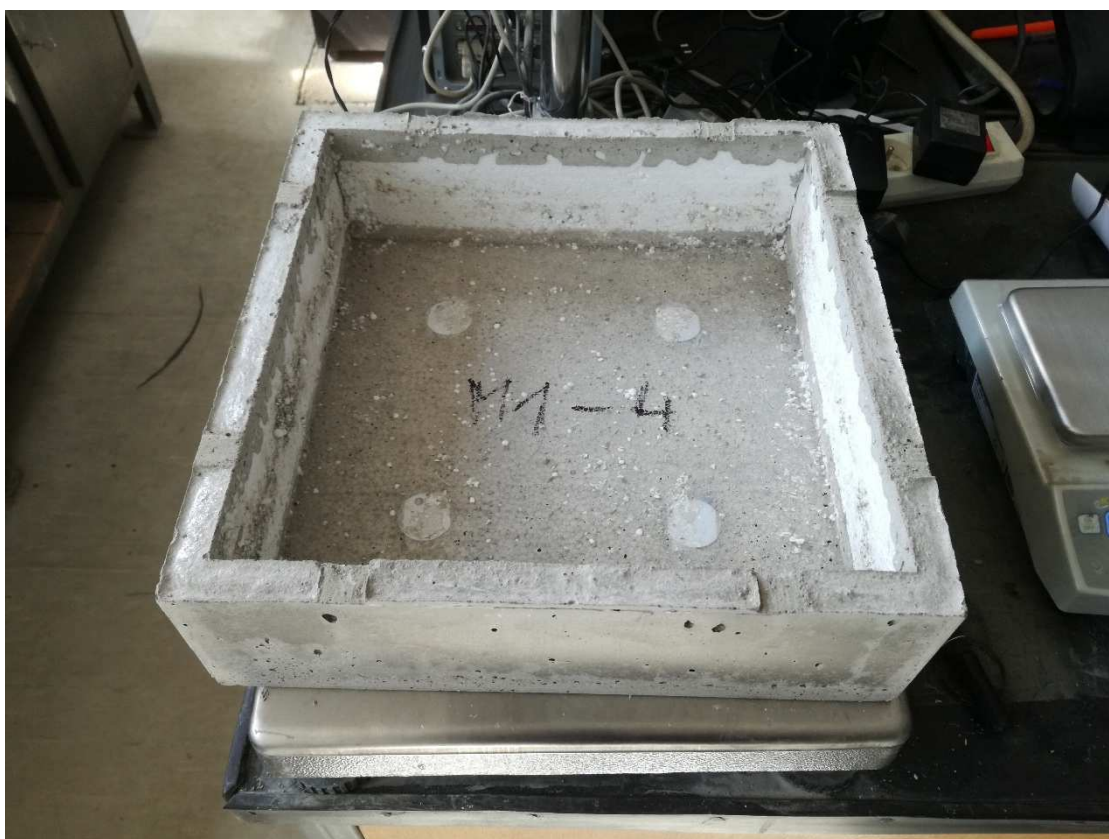
Obr. 117 Vybetonovaný zkušební vzorek – pohled zespodu
