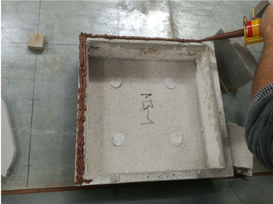
Obr. 123 Nanášení lepicího tmelu na zkušební vzorek
