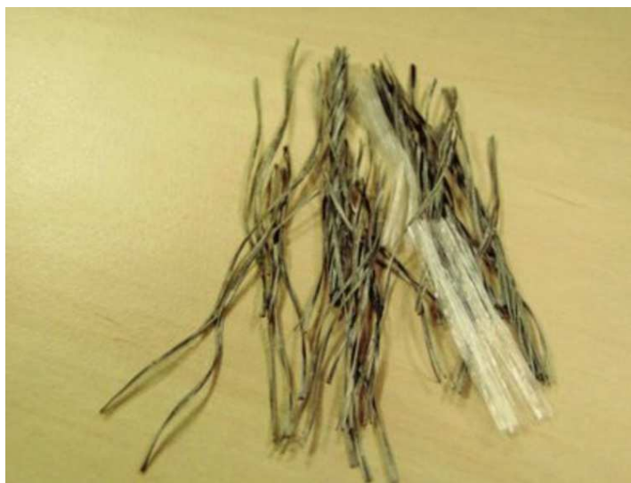
Obr. 64 Navržená polypropylenová vlákna Forta Ferro délka 54 mm – převzato z webu www.tonstav-service.cz
