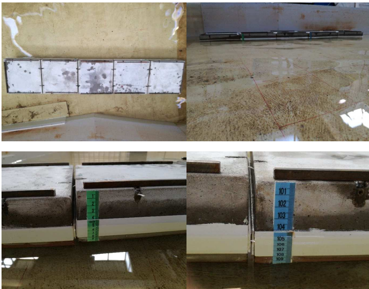
Obr. 164 Fotografie skupiny zkušebních prvků při zatěžovacím stavu C7
