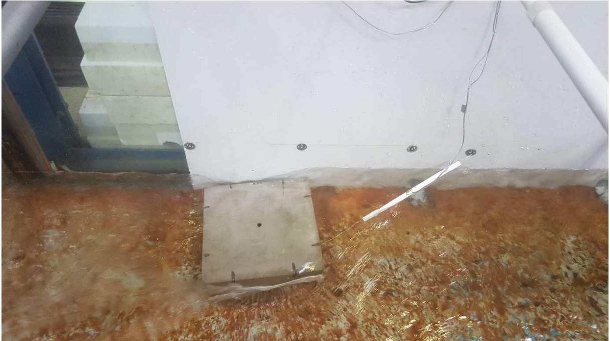
Obr. 270 Fotografie zkušebního prvku při zkoušce maximální rychlosti před jeho odplaváním
