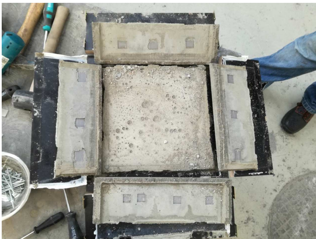
Obr. 115 Rozlámaný zkušební prvek
