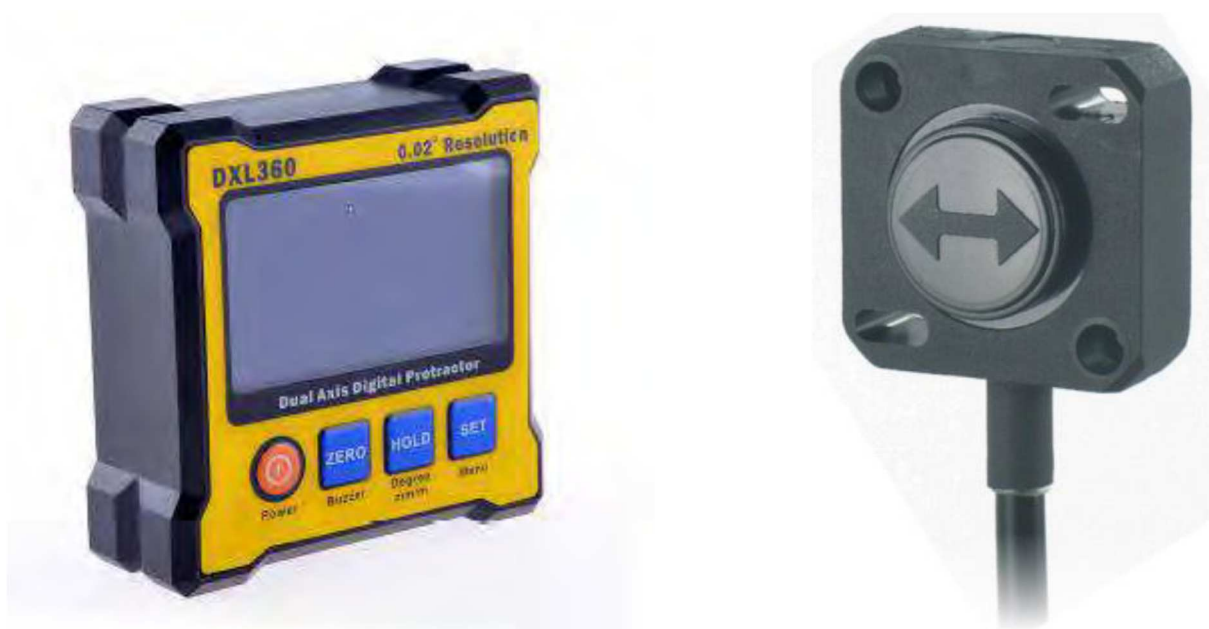
Obr. 130 Měřidla pro měření náklonů používaná pro hydraulické zkoušky: statické (vlevo), dynamické (vpravo)
