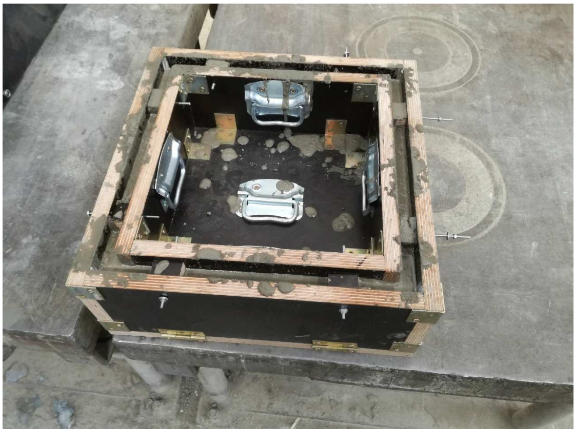
Obr. 114 Vybetonovaný zkušební prvek
