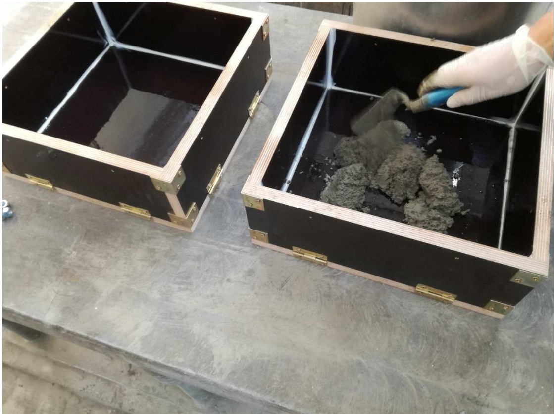
Obr. 113 Betonáž desky zkušebního prvku
