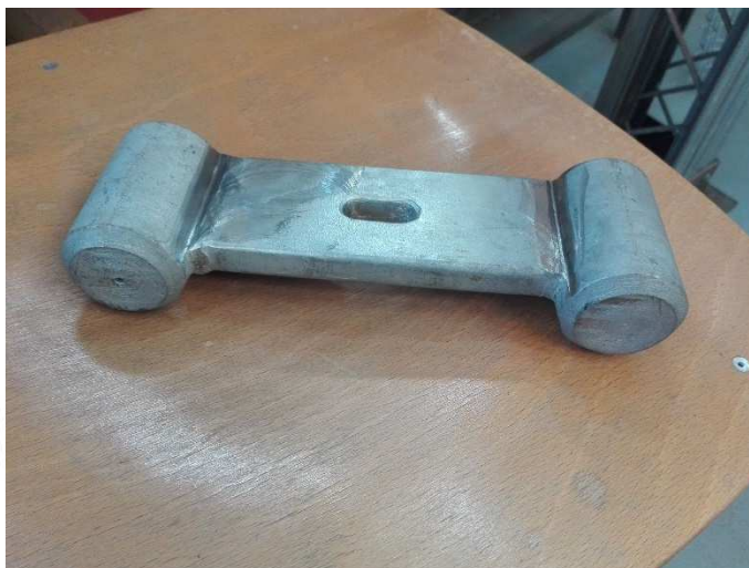
Obr. 83 Díl B – ocelový spojovací prvek tvarem připomínající činku sloužící k propojení dílů A
