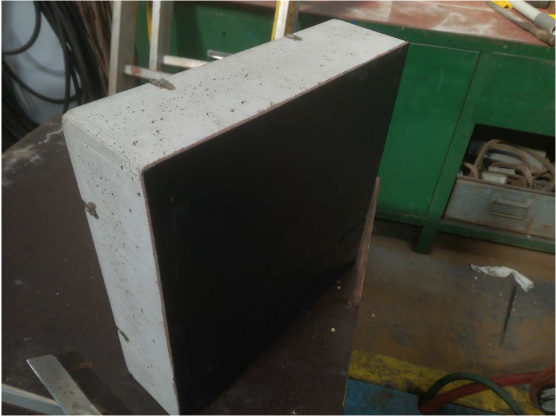
Obr. 125 Zkušební prvek s ořznutou fólií
