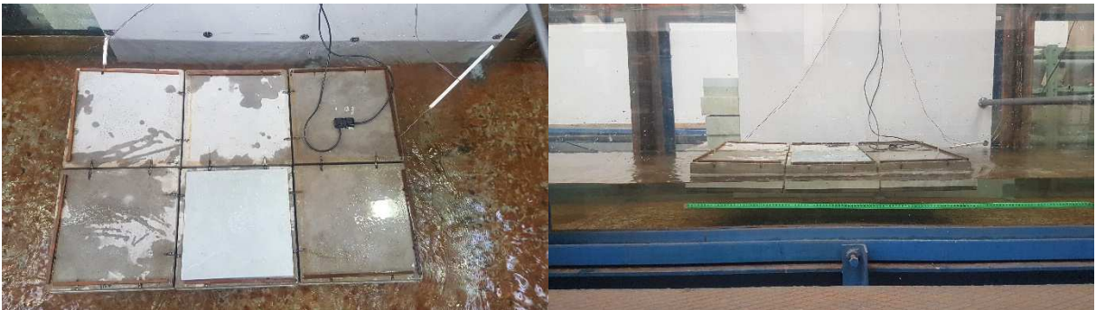
Obr. 243 Fotografie skupiny zkušebních prvků při zatěžovacím stavu Y9
