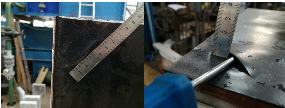
Obr. 162 Proříznutý otvor u zkušebního prvku reprezentující prasklý vzduchový vak
