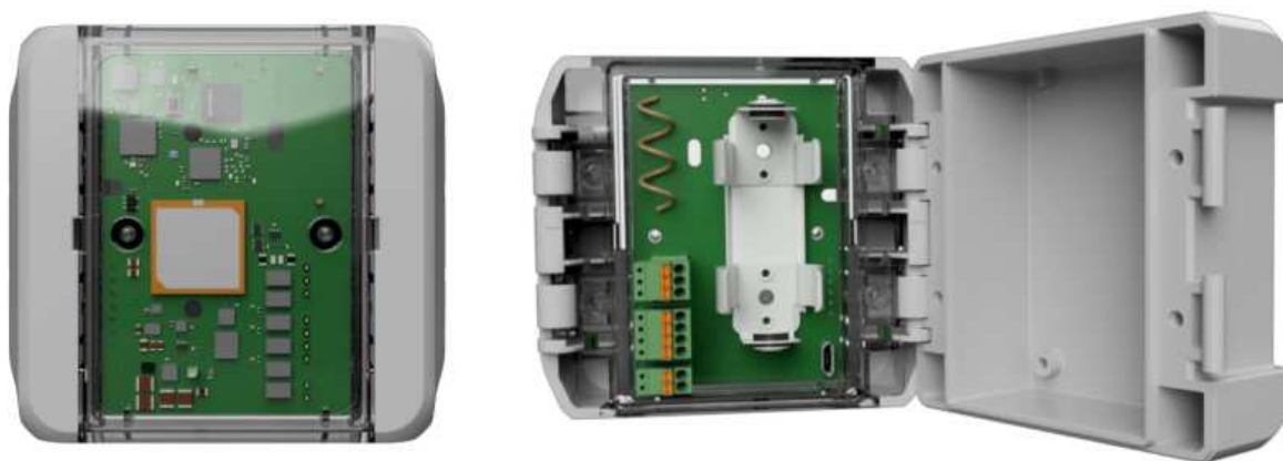
Obr. 103 Čidlo polohy na síti LoRa – Asset tracker Pro dodávané společností Foxconn Technology CZ, s.r.o.
