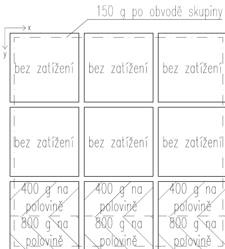
Obr. 181 Schéma zatěžovacího stavu D8
