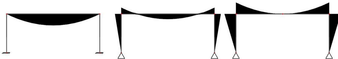
Obr. 5 - Průběh ohybového momentu (zleva): vetk. sloupy s kl. příčlí, dvoukloubov. rám, trojkloubov. rám
