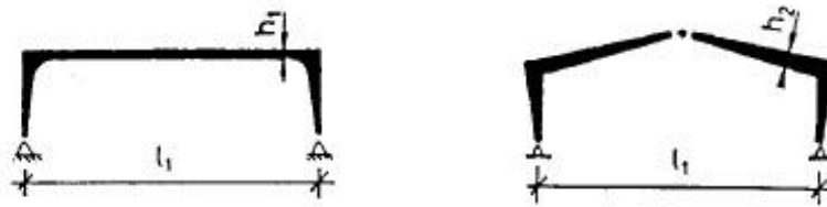
Obr. 4 - Dvoukloubový rám (vlevo) a trojkloubový rám (vpravo) [1]
