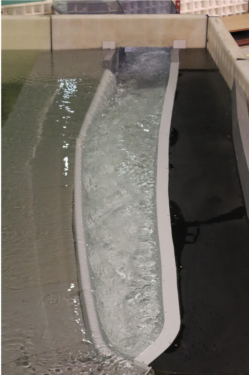
Obr. 8.5 Fotografie spadiště bezpečnostního přelivu při průtoku Q1000
