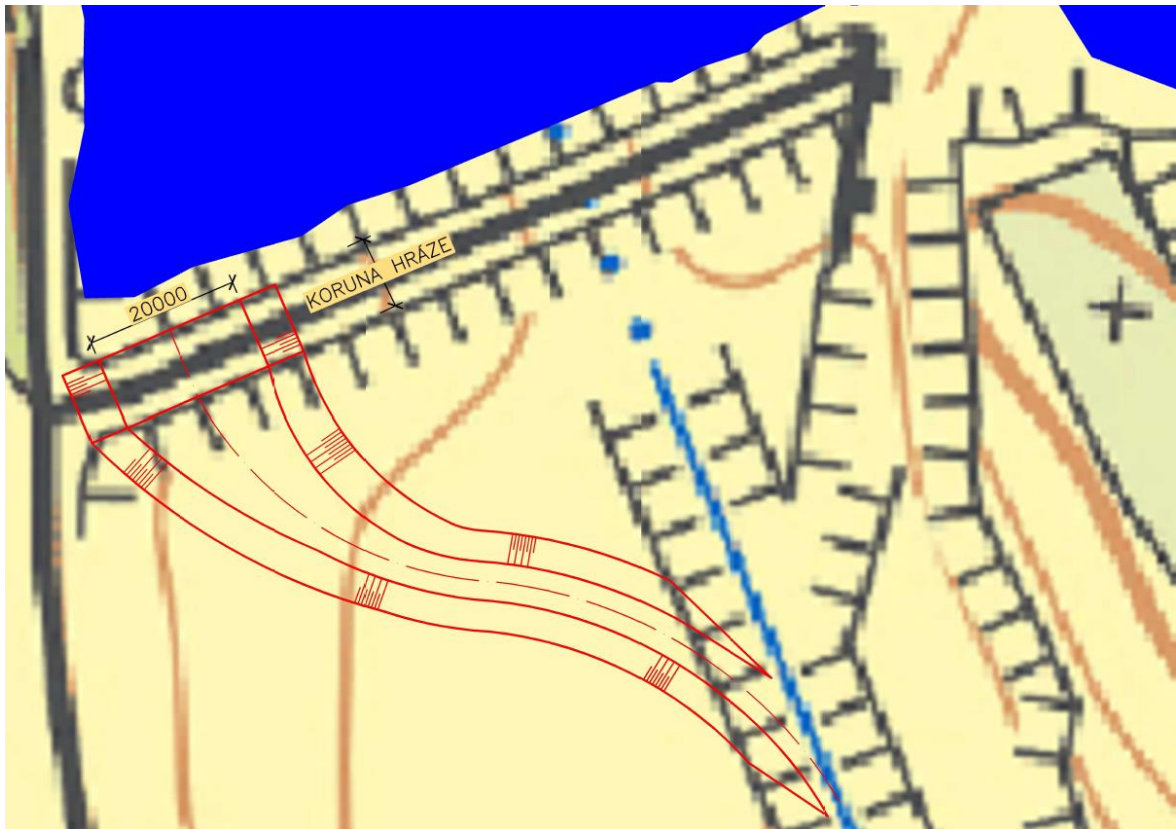
Obrázek 5.11 – Schéma návrhu nouzového přelivu
