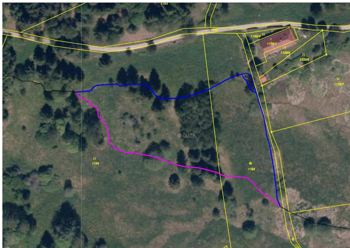
obr. 3.4.3 Schéma zobrazující trasu Hajného potoka. černě - trasa toku, fialově - trasa pravého ramene toku, modře - trasa levého ramene toku, žlutě - hranice parcel (Podklad: ortofotomapa + katastrální mapa)
