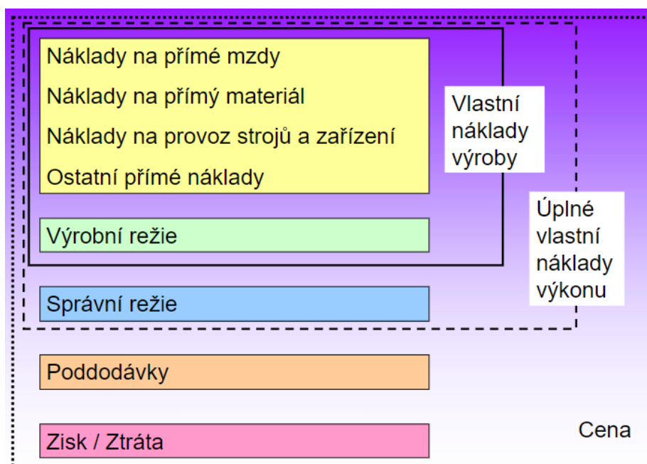
Obr. 36: Kalkulační vzorec používaný ve stavebnictví [49, str. 31]
