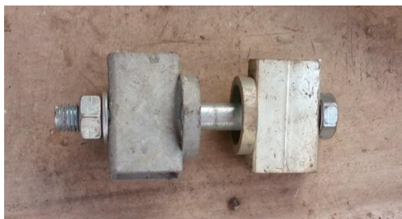
Obr. 29: Stahovací šroub modulů [Autor]
