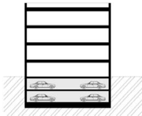
Obrázek 21 Typ garážového podlaží Zdroj: www.iprpraha.cz
