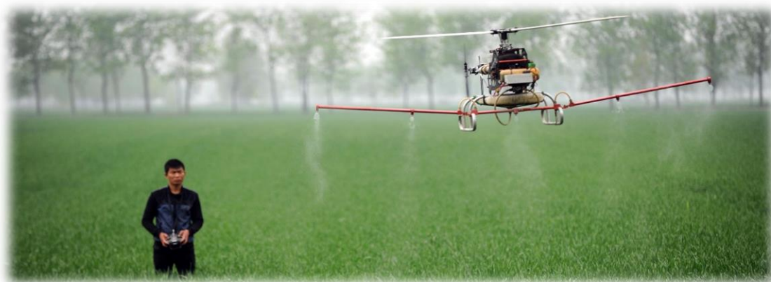
Obrázek 9: Jednorotorový dron pro postřik hnojiv, vlevo pilot pro měřítko velikosti
