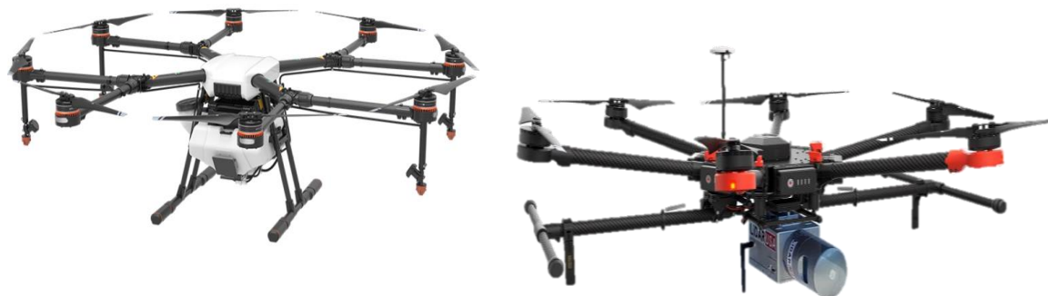
Obrázek 6: Drony pro komerční využití (vlevo s rozprašovačem na hnojiva a nádobou, vpravo s laserovým skenerem)
