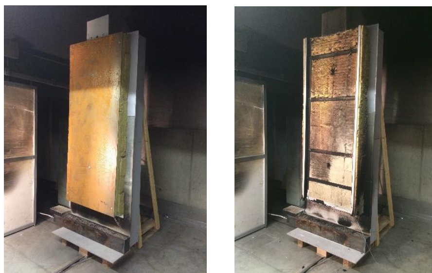
obr. 65 Vzorek 01 – Referenční scénář před zkouškou vlevo; po zkoušce a sejmutí ocelové desky Cor-Ten vpravo, první dvě řady na spodní části čedičové vaty Isover UNI byly výrazně zkrěhlé
