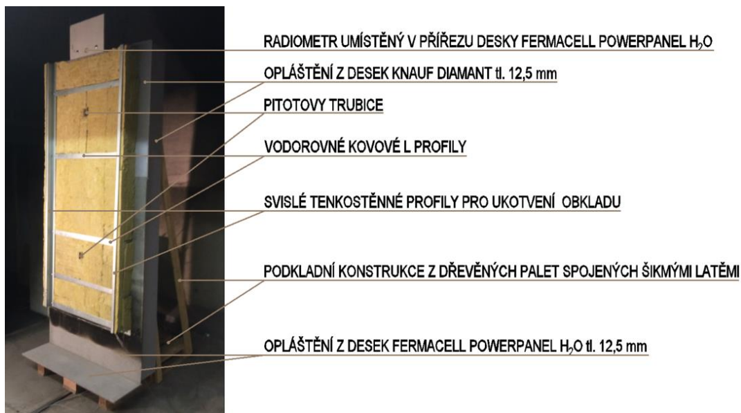
obr. 64 Popis sestaveného vzorku bez obkladové desky, vyznačeny pitotovy trubice a radiometr
