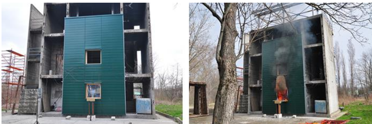
obr. 24 Ukázka zkoušky dle MSZ 14800-6, zleva: fasáda před zkouškou, fasáda při zkoušce 4
