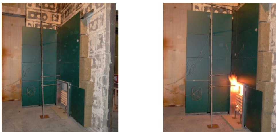
obr. 25 Ukázka zkoušky dle Önorm B 3800-5; zleva: fasádní vzorek před zkouškou a během zkoušky 5
