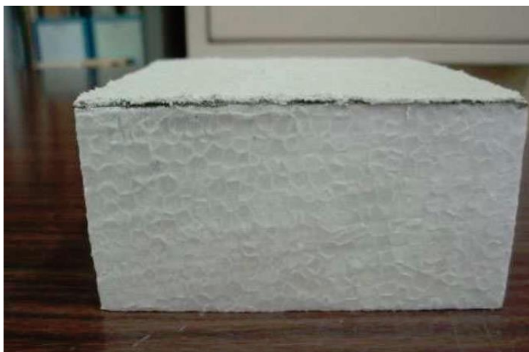
obr. 5 Vzorek EPS ve skladbě kontaktního zateplovacího systému [7]
