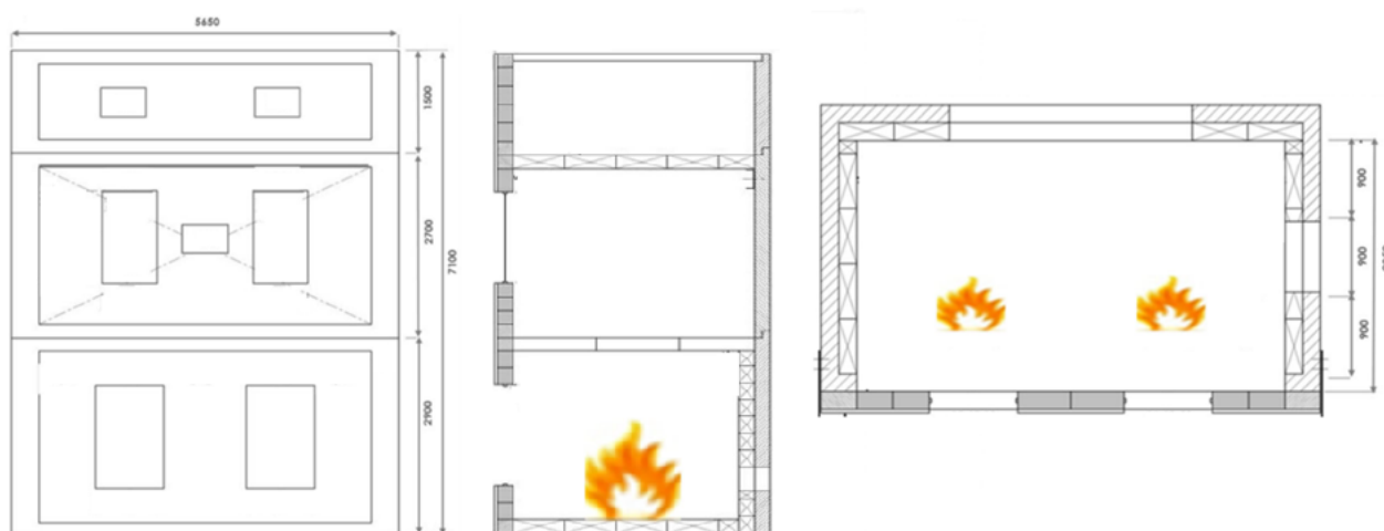
obr. 23 Schéma zkoušky dle Lepir 2, zleva: pohled na vzorek fasády, svislý řez a půdorys [21]
