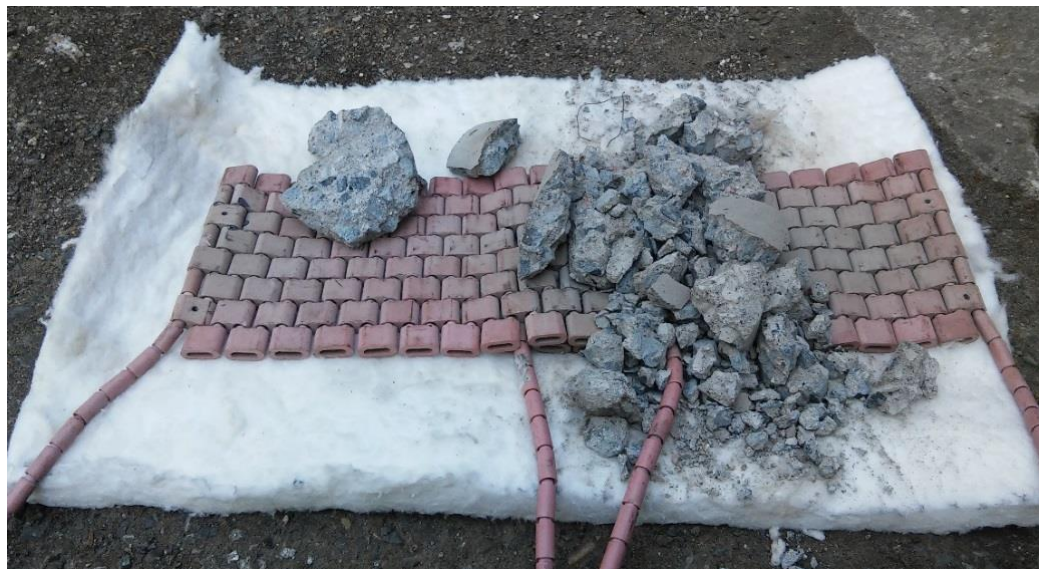
Obr. 31 – Stav vzorku po odštěpení [33].
