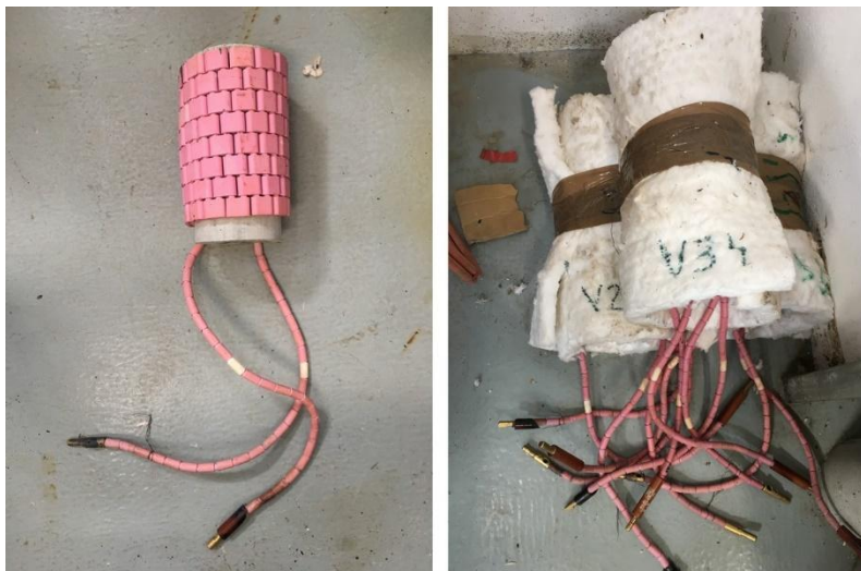
Obr. 29 – Vzorek zabalený do keramické dečky (vlevo) a vzorky připravené ke zkoušce (vpravo).
