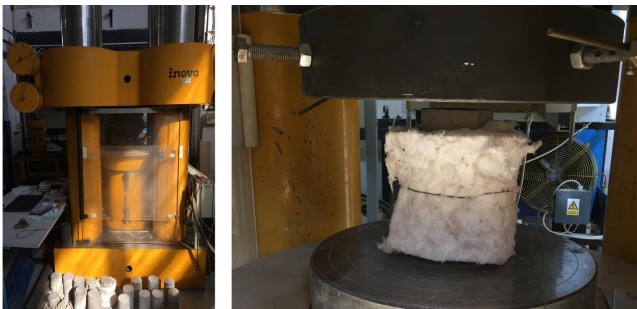
Obr. 33 – Lis Inova 200 F (vlevo) a vzorek umístěný v lisu (vpravo).
