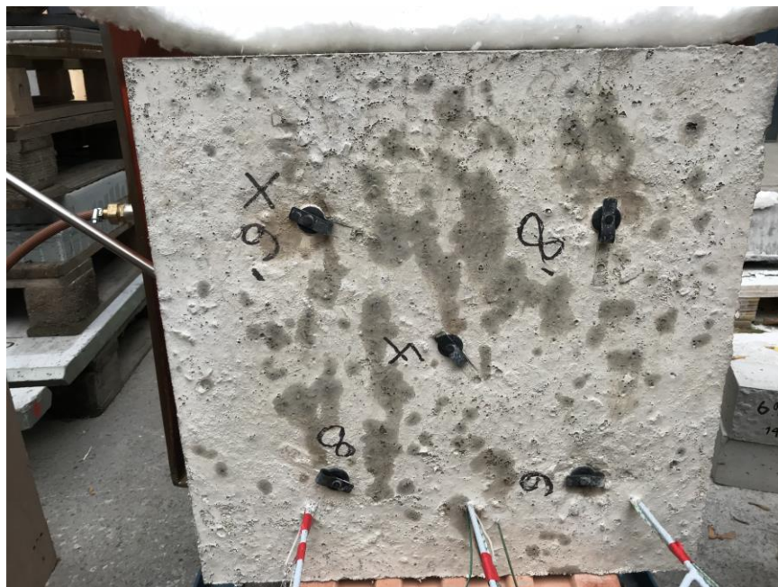
obr. 59 Odpařování vlhkosti na neohřívané straně
