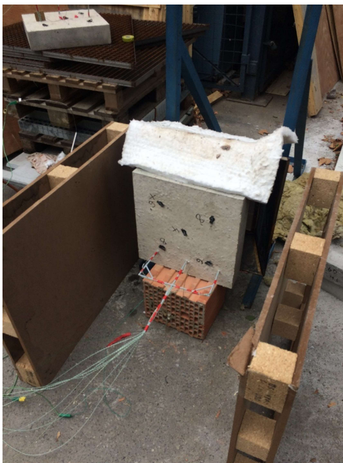
Obrázek 47 – Vzorek číslo 2 pro určení plošné teploty v prvku
