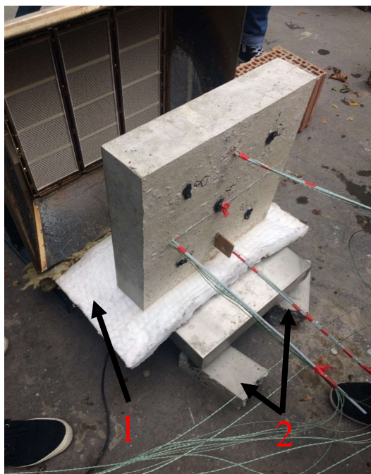
Obrázek 38 – 1) Izolace váhy, 2) Vyrovnávací hranoly
