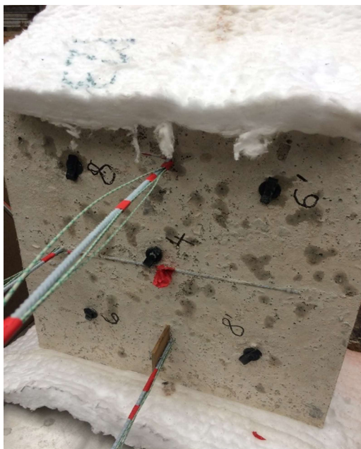
Obrázek 45 – viditelné vypařování vody v betonu zaznamenaná v 37. minutě
