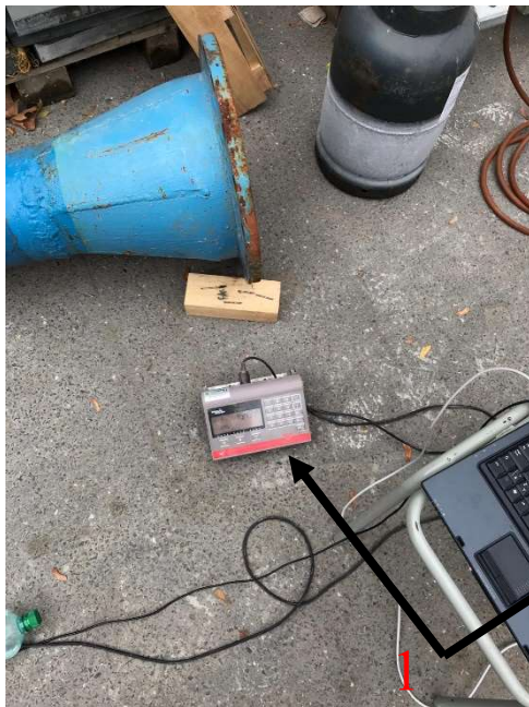
Obrázek 43 – 1) Digitální váha zaznamenávající hmotnost úbytku vody po celou dobu testu
