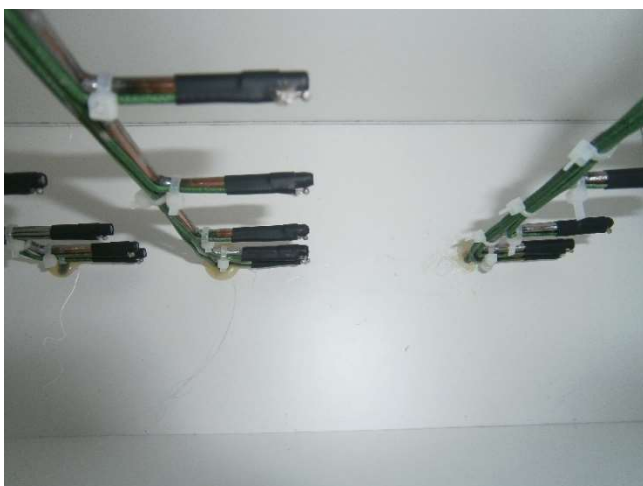
Obrázek 22: Tyčový měděný nosič [17]
