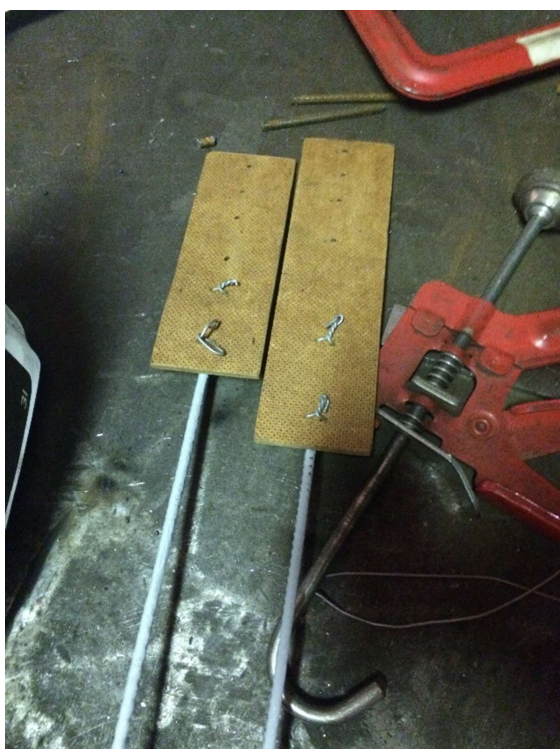
Obrázek 28 - Detail upevnění vodící tyče
