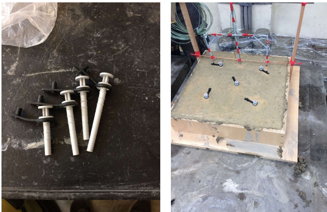
Obrázek 35 – Vkládání hygropinových pouzder do vzorku
