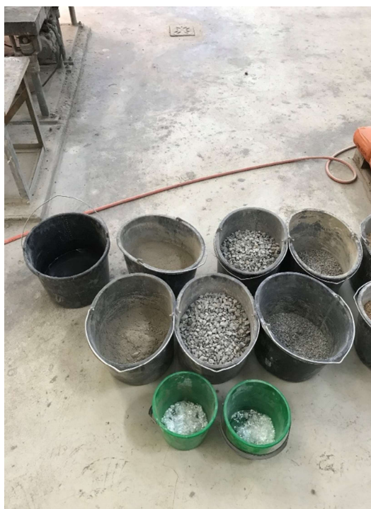
Obrázek 32 – Vážení a příprava surovin, pro výrobu vzorku
