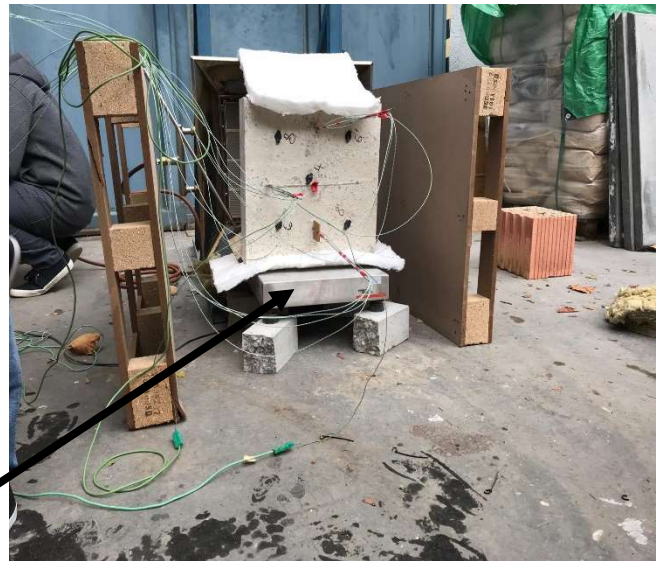
Obrázek 43 – 1) Digitální váha zaznamenávající hmotnost úbytku vody po celou dobu testu
