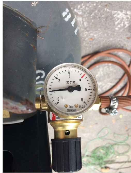
Obrázek 42 – Tlaková láhev, ukázka adekvátního tlaku na manometru pro měření experimentu
