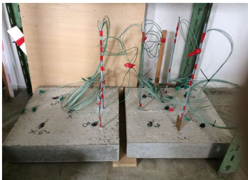
Obrázek 37 – Oba odbedněné vzorky připravené k experimentálnímu měření
