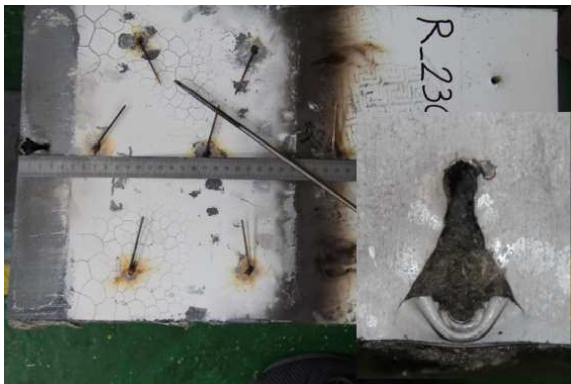
obr. 39 Porušení panelu SPA230E k plechu tl. 8 mm při teplotě 450 °C
