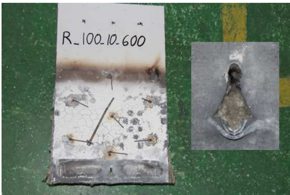
obr. 36 Porušení panelu SPA100E k plechu tl. 10 mm při teplotě 600 °C
