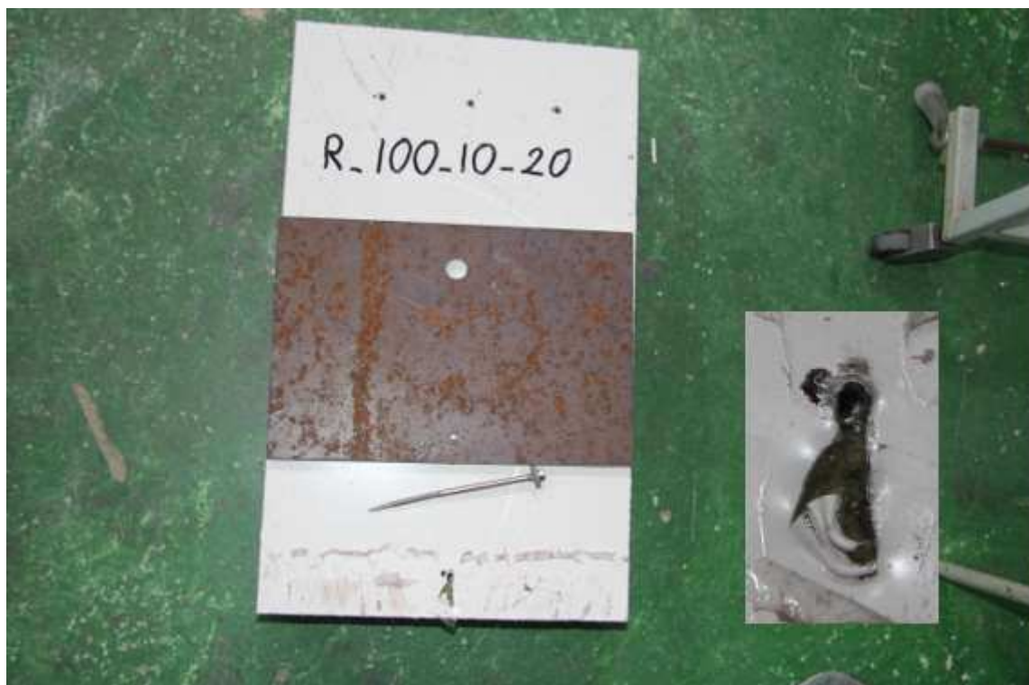
obr. 33 Porušení panelu SPA100E k plechu tl. 10 mm při teplotě 20 °C
