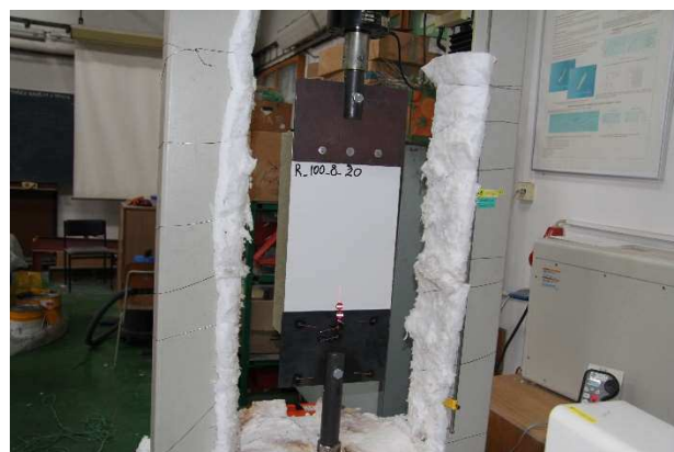
obr. 23 Ukotvení vzorku pomocí 3 šroubů vedle sebe
