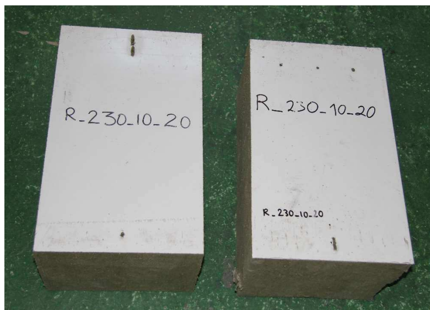
obr. 24 Porovnání deformací špatného a správného uchycení vzorku po průběhu zkoušky
