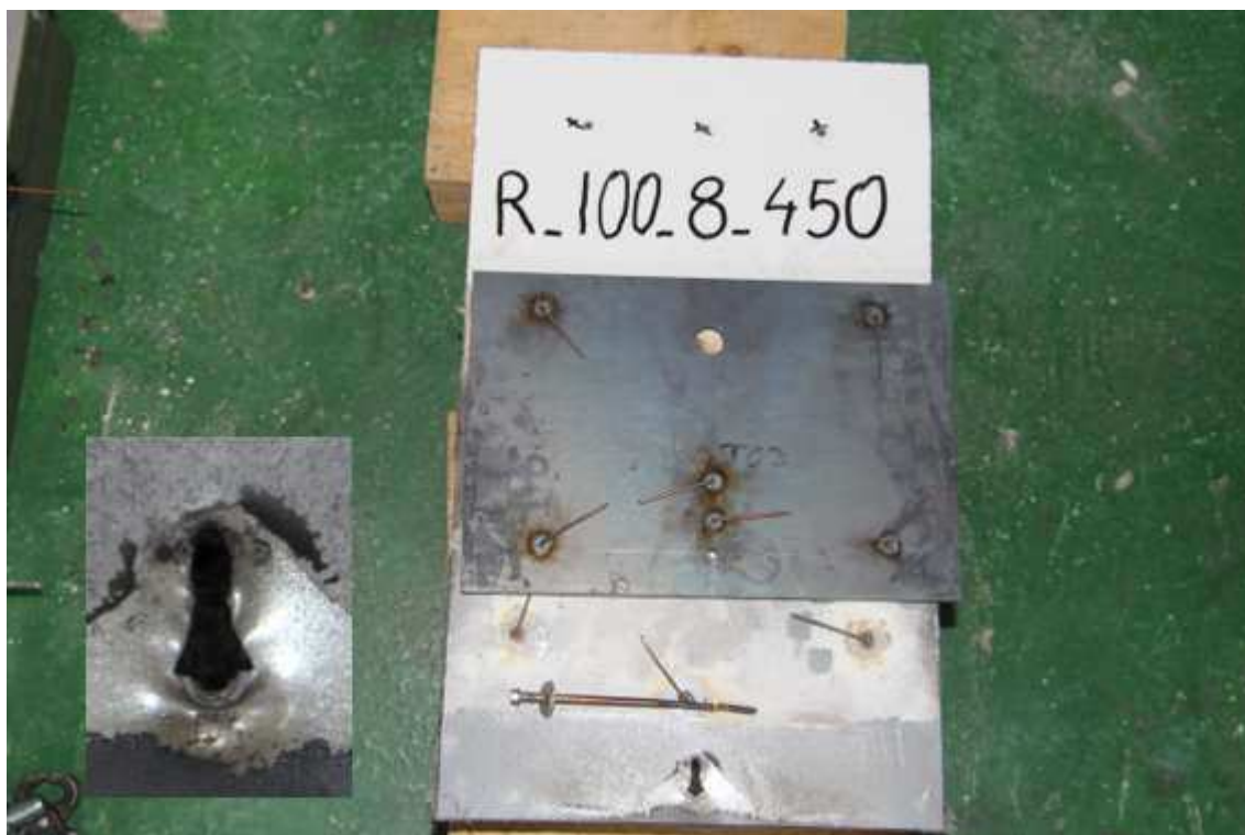
obr. 31 Porušení panelu SPA100E k plechu tl. 8 mm při teplotě 450 °C
