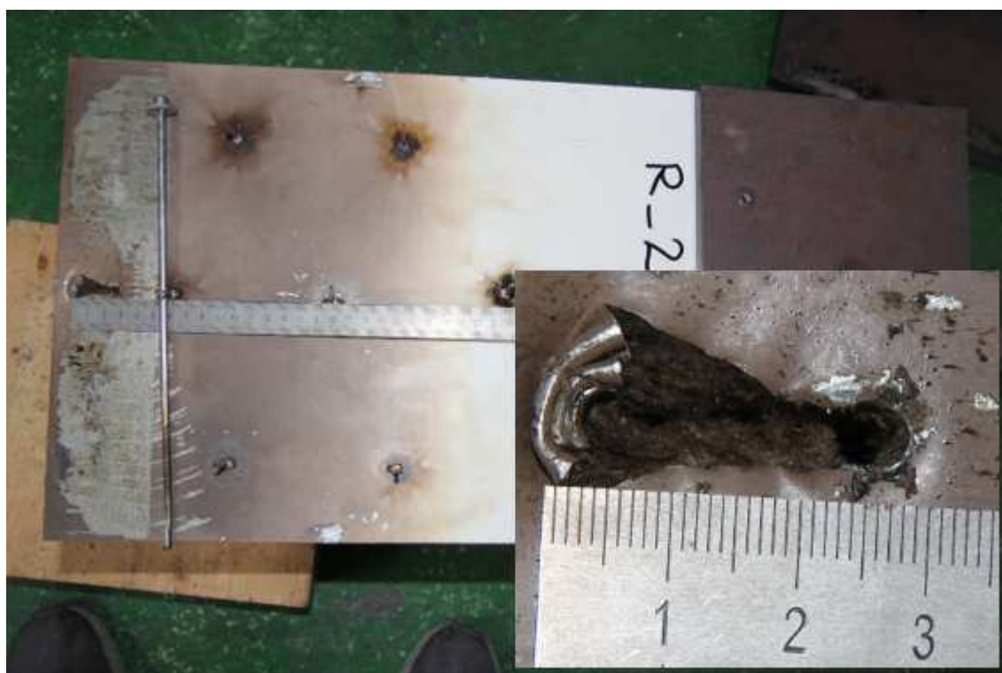
obr. 42 Porušení panelu SPA230E k plechu tl. 10 mm při teplotě 300 °C
