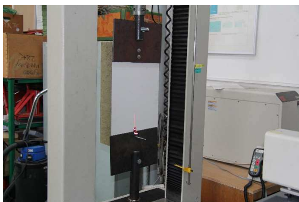
obr. 22 Ukotvení vzorku pomocí 2 šroubů nad sebou
