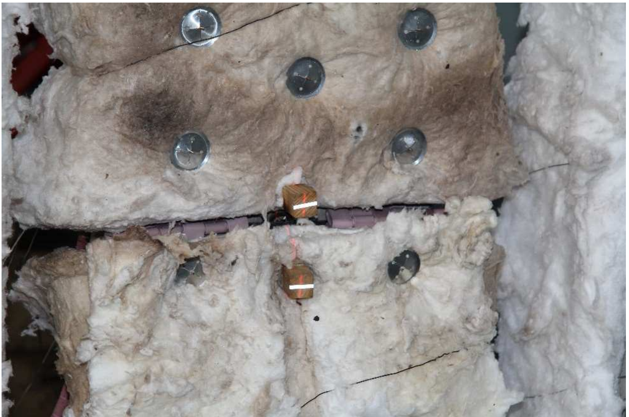
obr. 26 Laser extenzometru a vzorek zkoušený za zvýšené teploty
