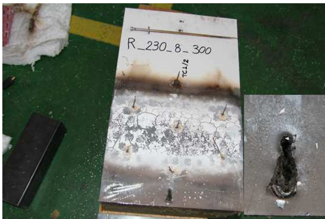
obr. 38 Porušení panelu SPA230E k plechu tl. 8 mm při teplotě 300 °C
