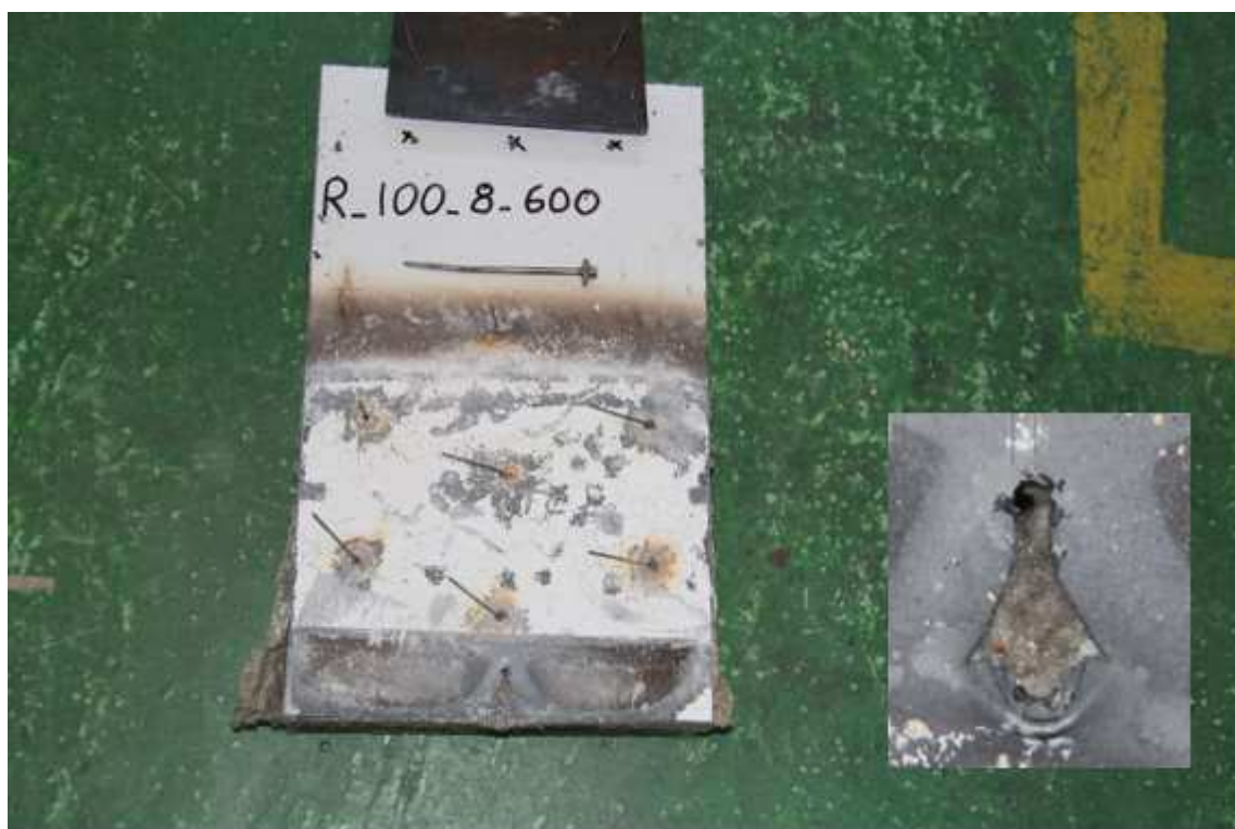
obr. 32 Porušení panelu SPA100E k plechu 8 mm při teplotě 600 °C
