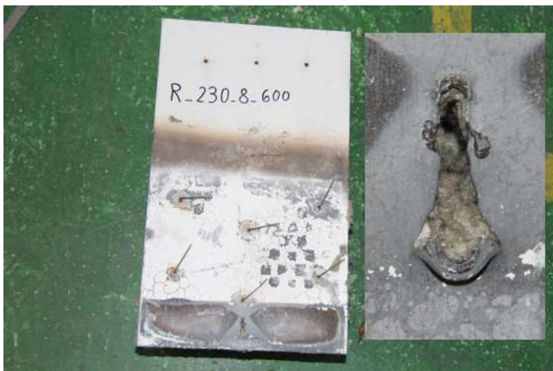
obr. 40 Porušení panelu SPA230E k plechu tl. 8 mm při teplotě 600 °C
