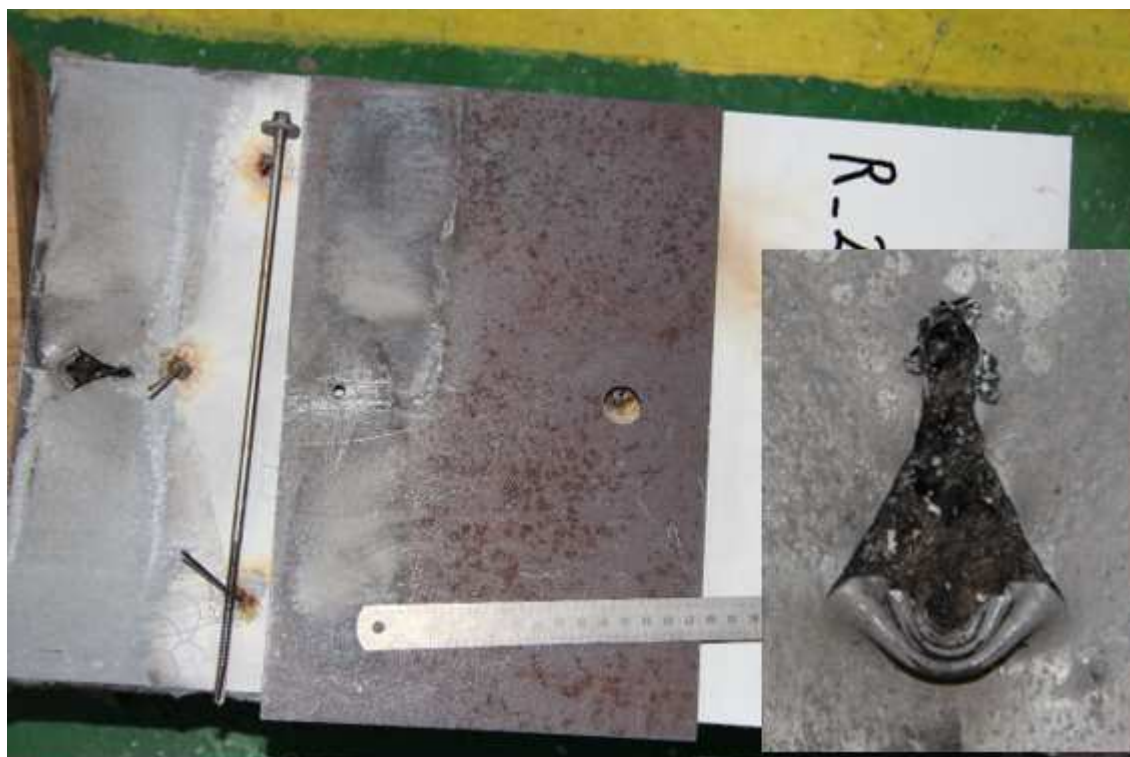
obr. 43 Porušení panelu SPA230E k plechu tl. 10 mm při teplotě 450 °C
