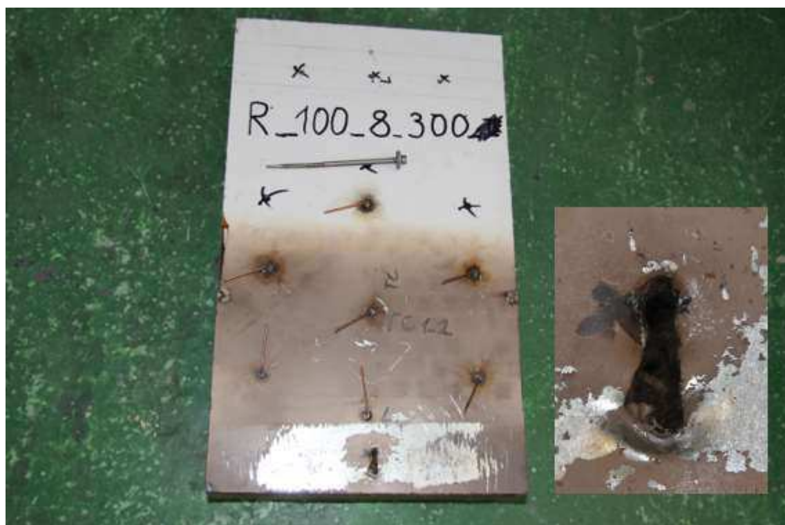
obr. 30 Porušení panelu SPA100E k plechu tl. 8 mm při teplotě 300 °C
