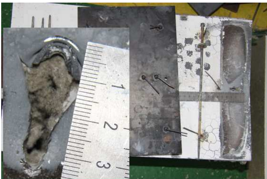
obr. 44 Porušení panelu SPA230E k plechu tl. 10 mm při teplotě 600 °C
