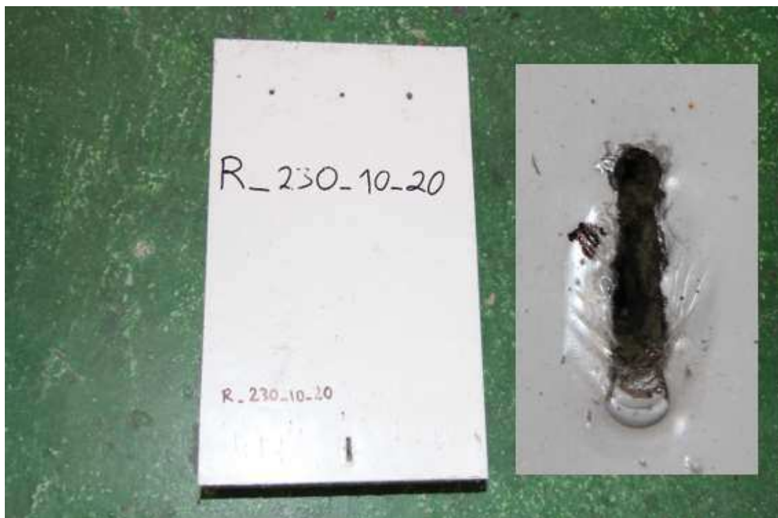
obr. 41 Obr. Porušení panelu SPA230E k plechu tl. 10 mm při teplotě 20 °C
