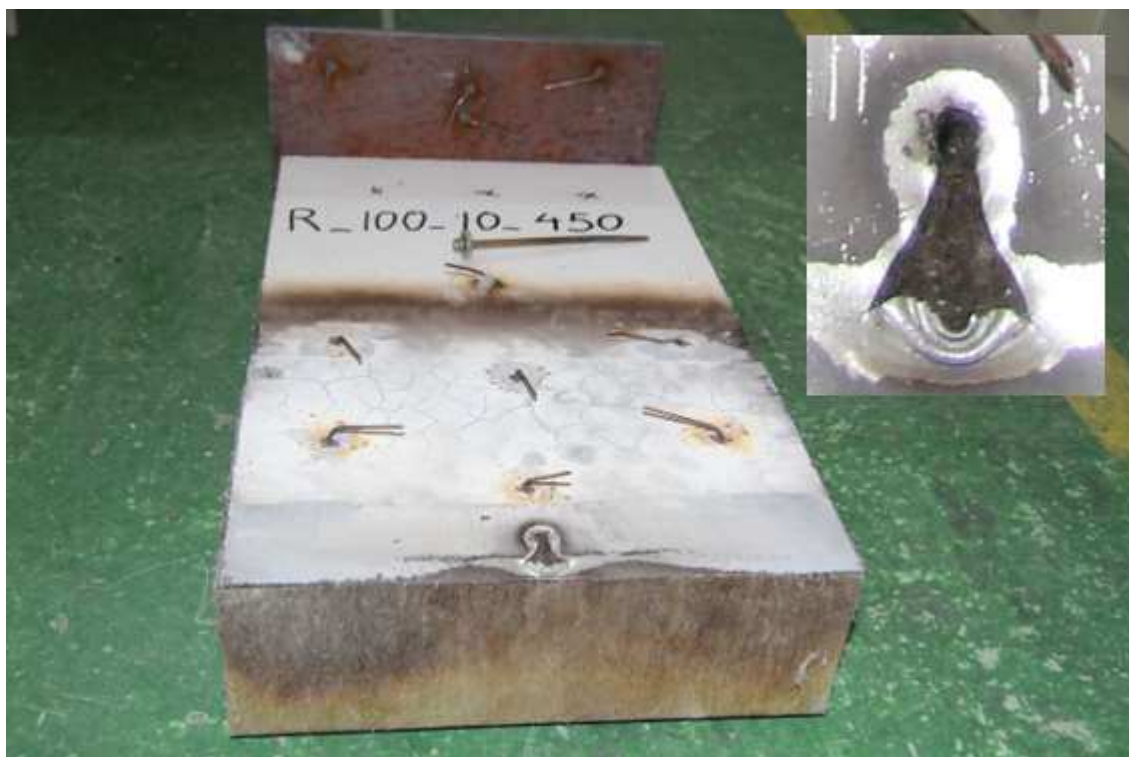
obr. 35 Porušení panelu SPA100E k plechu tl. 10 mm při teplotě 450 °C
