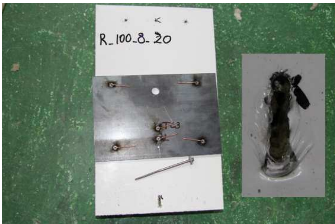
obr. 29 Porušení panelu SPA100E k plechu tl. 8 mm při teplotě 20 °C
