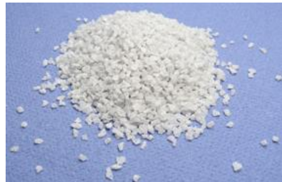
Obr. 5.3.3 Omílací granulát z ušlechtilého korundu [67]
