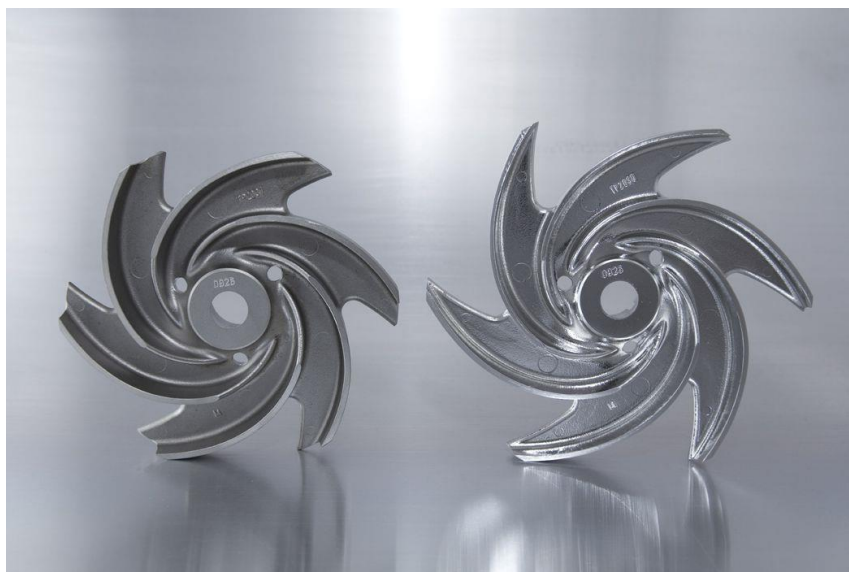
Obr. 5.5.2 Oběžné kolo čerpadla neleštěný (vlevo) a leštěný (vpravo) vzorky. HENKEL [63]
