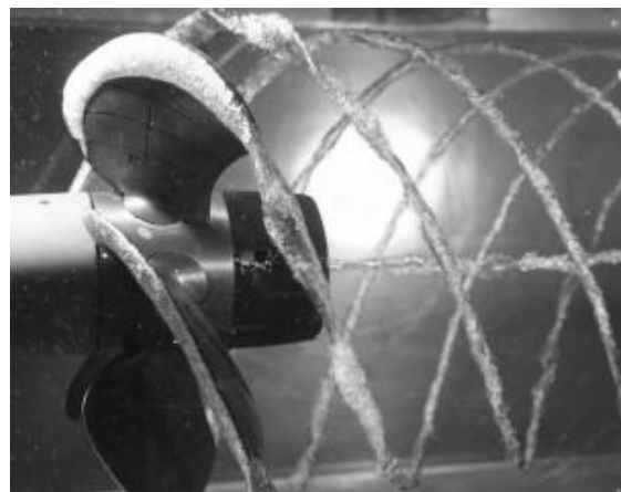
Obrázek 6: kavitace na lopatkách lodního šroubu
