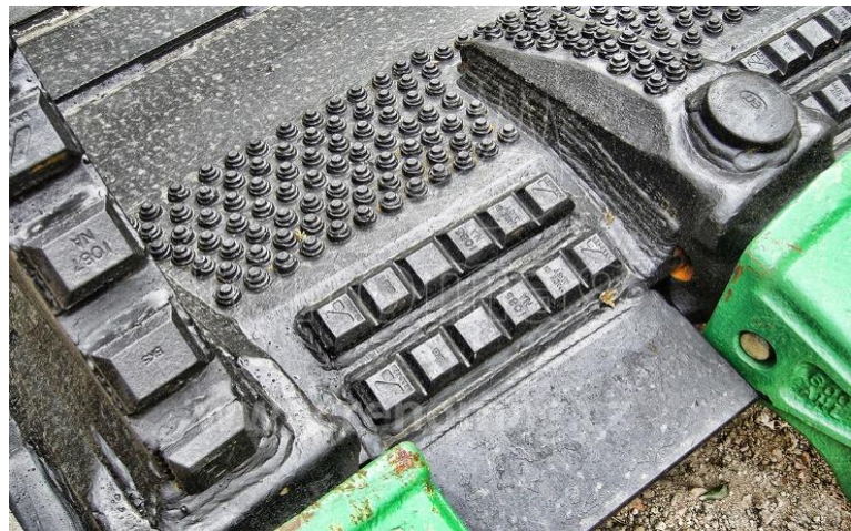
Obrázek 13: nakladač – ochrana pomocí pinů a VIDA prvků Renomag
