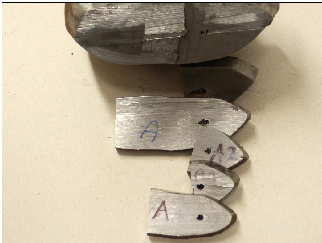
Obrázek 17: vnitřní vada u vzorku A
