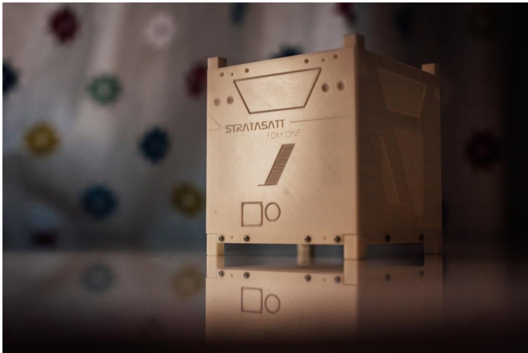
Obrázek 23: Prototyp elektrostatické solární plachetnice vyrobené technologií 3d tisku
