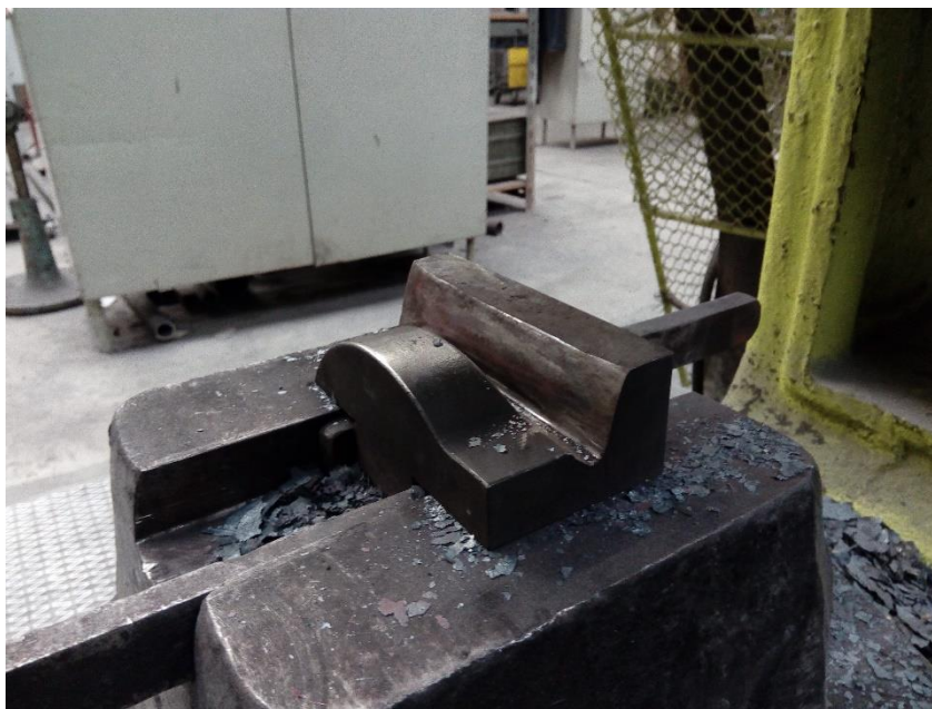
Obrázek 27, Tvářecí kovádla pro kování drážky táhla
