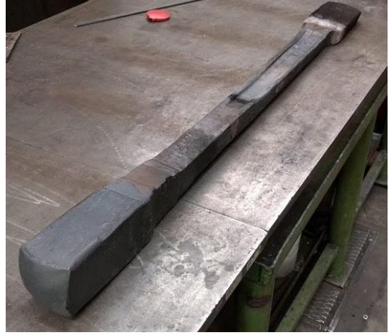
Obrázek 36, Částečně vykovaná drážka polotovaru
