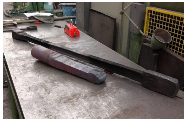
Obrázek 32, Částečně vykováný krok 3 vedle dokončeného výkovku
