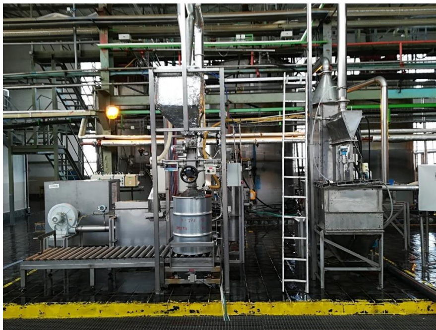
Obr. 7 – Sušárna uranového koncentrátu v hale č. 4 CHS I – sušící linka (vlastní zdroj)
