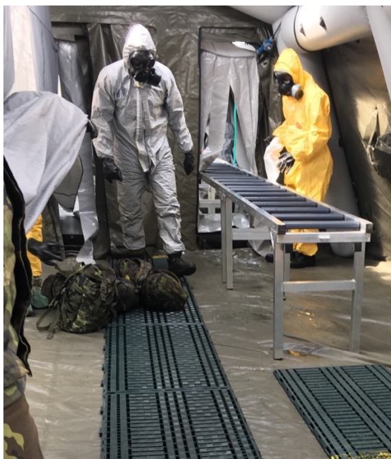
Obrázek 6 Pojezdový systém pro dekontaminaci raněných osob na lehátkách (vlastní)
