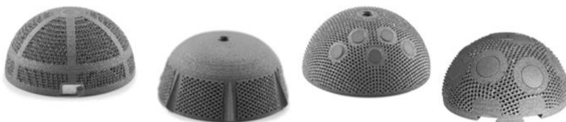
Obrázek 1.8: Ukázka možností 3D tisku od společnosti Prospan. Monobloky acetabulárních jamek z titanové slitiny, které mají pórovitý povrch. Převzato a upraveno z [48].
