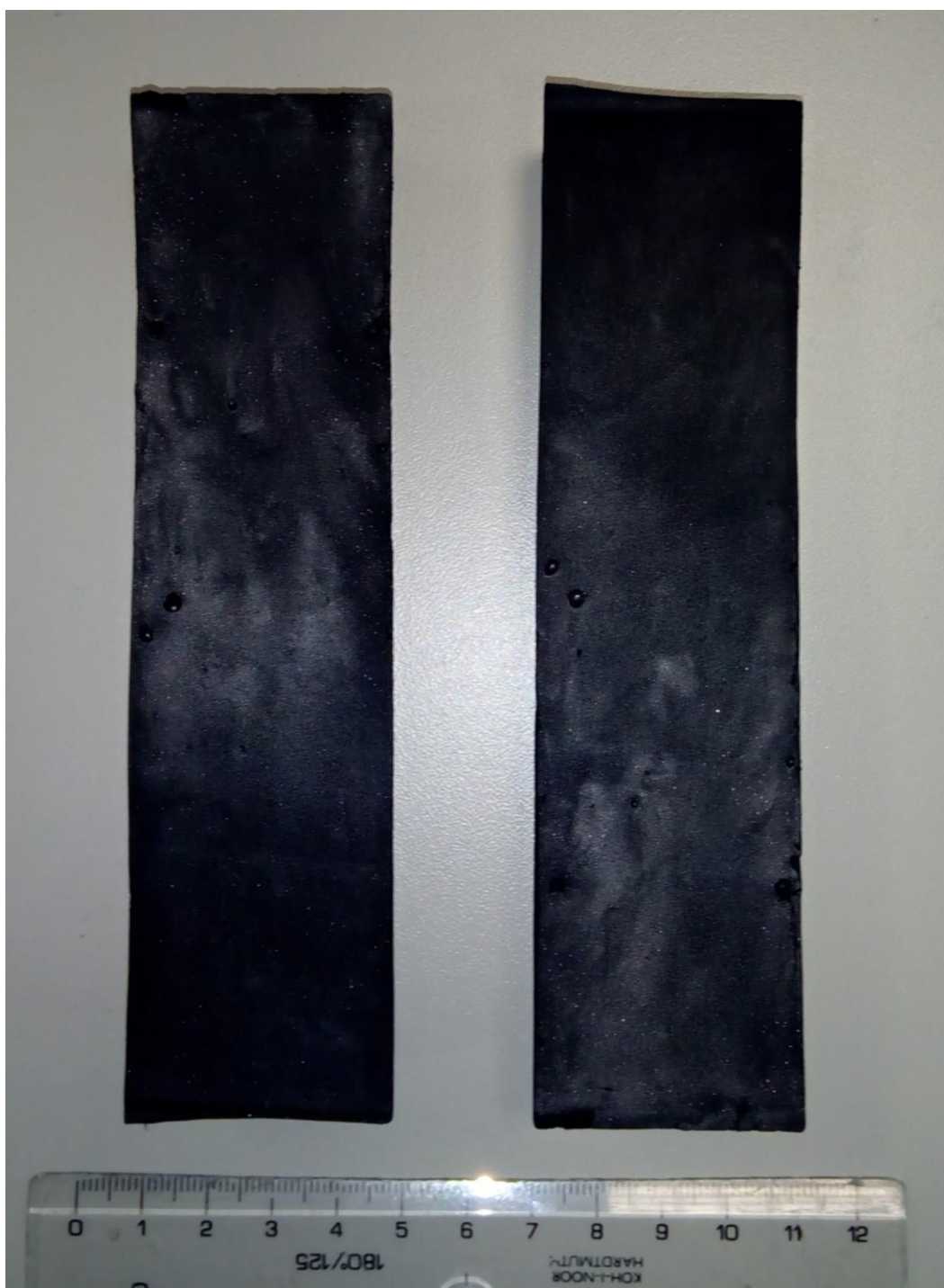
Obrázek 3.20: Řez fantomem cévní mozkové příhody pro zjištění množství bublin, které ve fantomu zůstaly.
