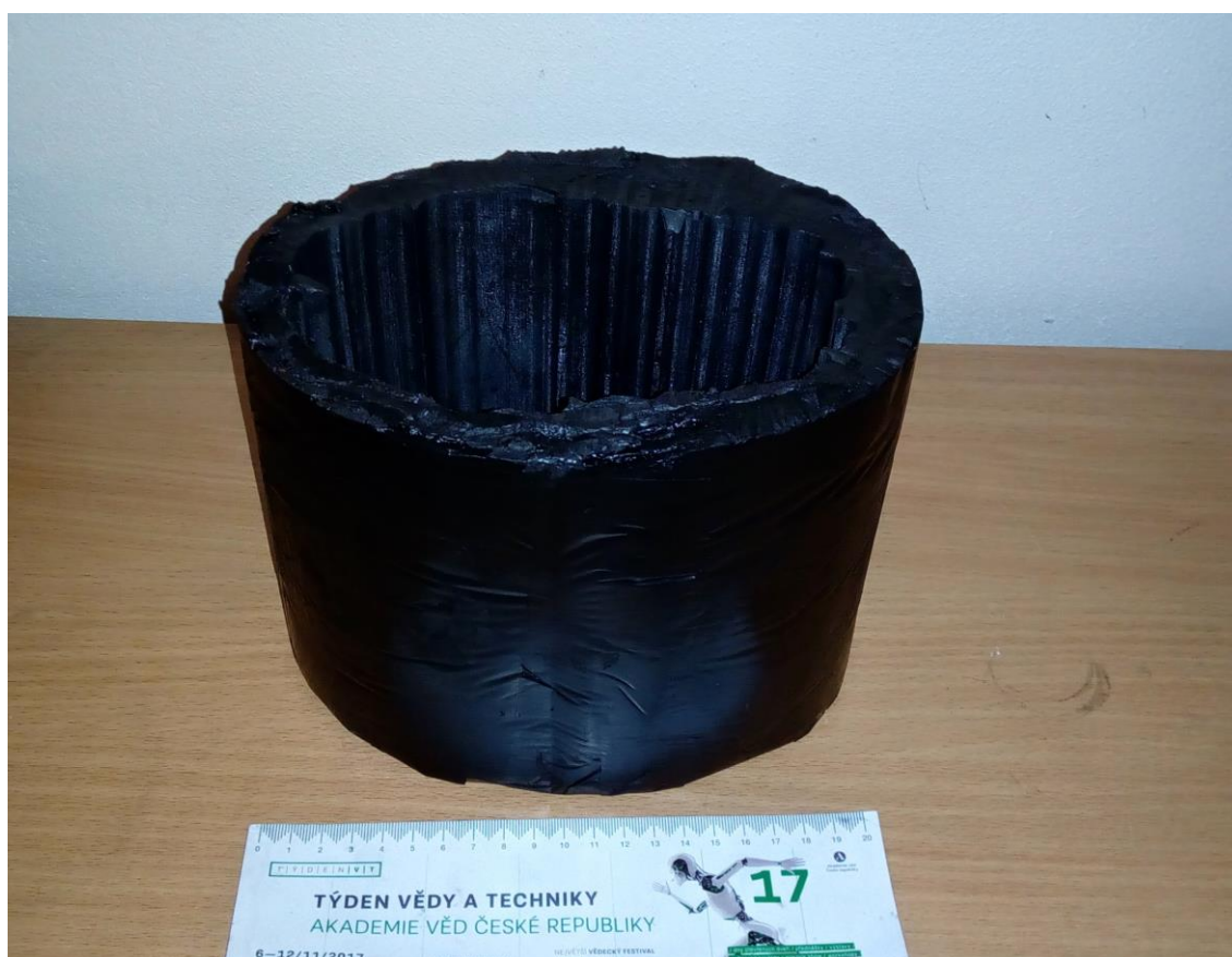
Obrázek 3.16: Hotová forma suchého fantomu verze 2, která obsahuje kůži s podkožním tukem, kost a mozkomíšni mok. Forma je připravená na nalití tekutého fantomu mozku a vložení fantomů cévní mozkové příhody.
