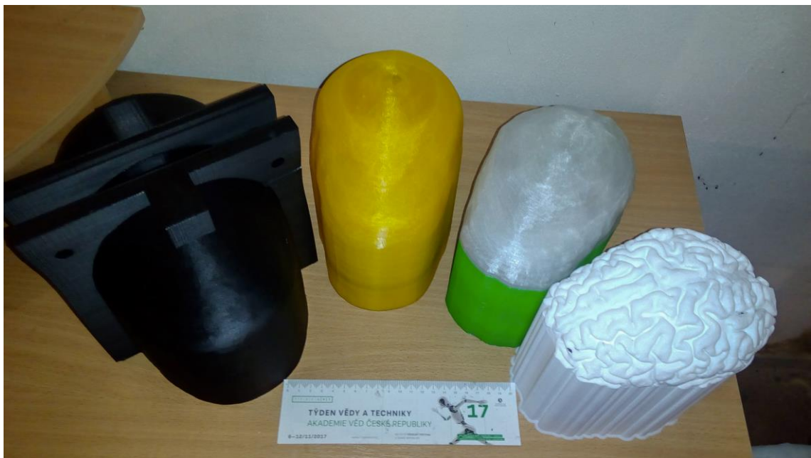
Obrázek 3.3: Vytisknuté 3D anatomické formy lidské hlavy, které ještě více připomínají skutečnou anatomii.
