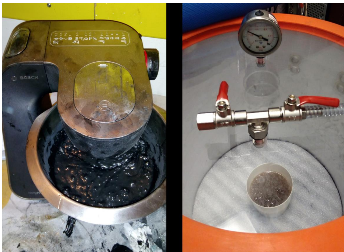
Obrázek 2.9: Míchání směsi všech složek v mixéru (vlevo) a vakuování směsi v podtlakové nádobě (vpravo).
