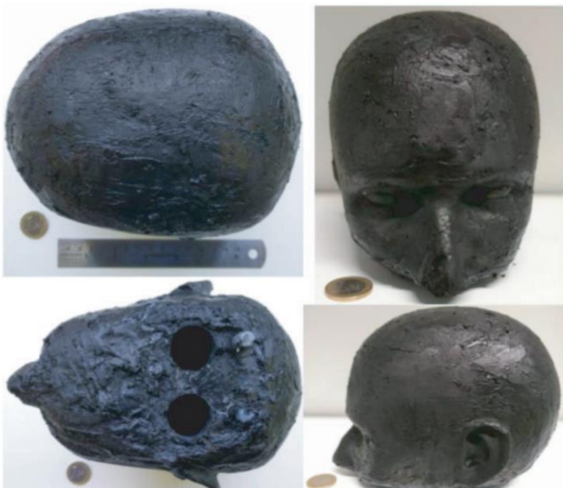
Obrázek 1.6: Dielektricky a anatomicky realistický fantom z polyuretanu, který je časově stálý a umožňuje vkládání fantomů CMP. Tento fantom je vyroben pouze ze dvou vrstev (mozek a okolní tkáň) a umožňuje vkládání fantomu CMP pouze na dvě pozice. Převzato a upraveno z [28].
