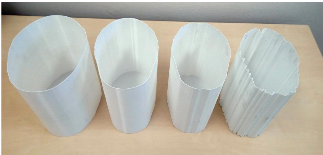
Obrázek 3.1: Formy pro odlévání podélně homogenního fantomu lidské hlavy vytištěné na 3D tiskárně. Verze 1 s tenkými stěnami a nerozebíratelnou vnější formou.
