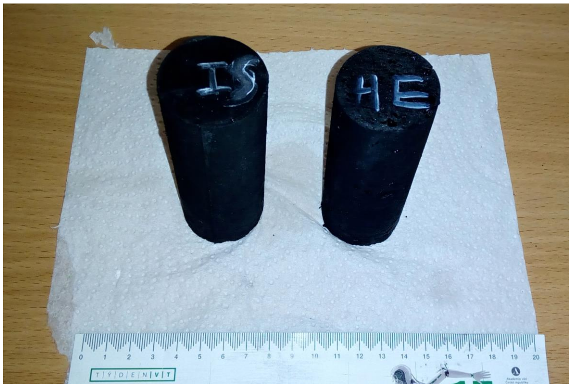
Obrázek 3.18: Fantomy ischemické (vlevo) a hemoragické (vpravo) cévní mozkové příhody.
