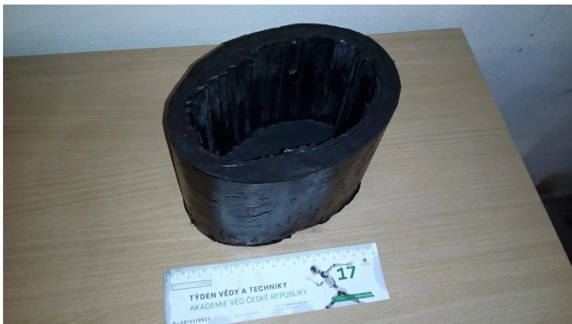
Obrázek 3.14: Hotová forma suchého fantomu verze 1, která obsahuje kůži s podkožním tukem, kost a mozkomíšní mok. Forma je připravená na nalití tekutého fantomu mozku a vložení fantomů cévní mozkové příhody.
