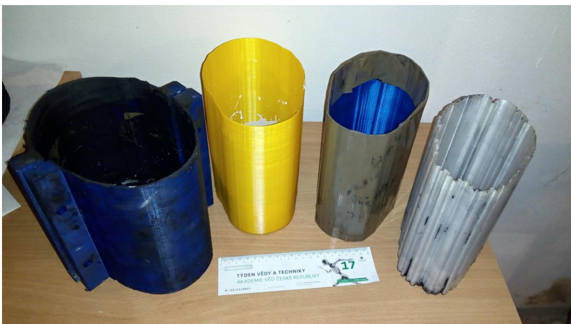
Obrázek 3.2: Formy pro odlévání podélně homogenního fantomu lidské hlavy vytištěné na 3D tiskárně. Verze 2 s tlustšími stěnami, díky kterým jsou pevnější a s rozebíratelnou vnější formou. Na formách je patrné jejich použití.
