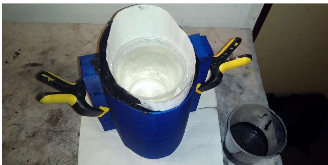
Obrázek 2.11: Odlévání první vrstvy (kůže s tukem) do vytištěných forem. Vpravo je odlitý kontrolní vzorek, na kterém budou měřeny dielektrické vlastnosti směsi.
