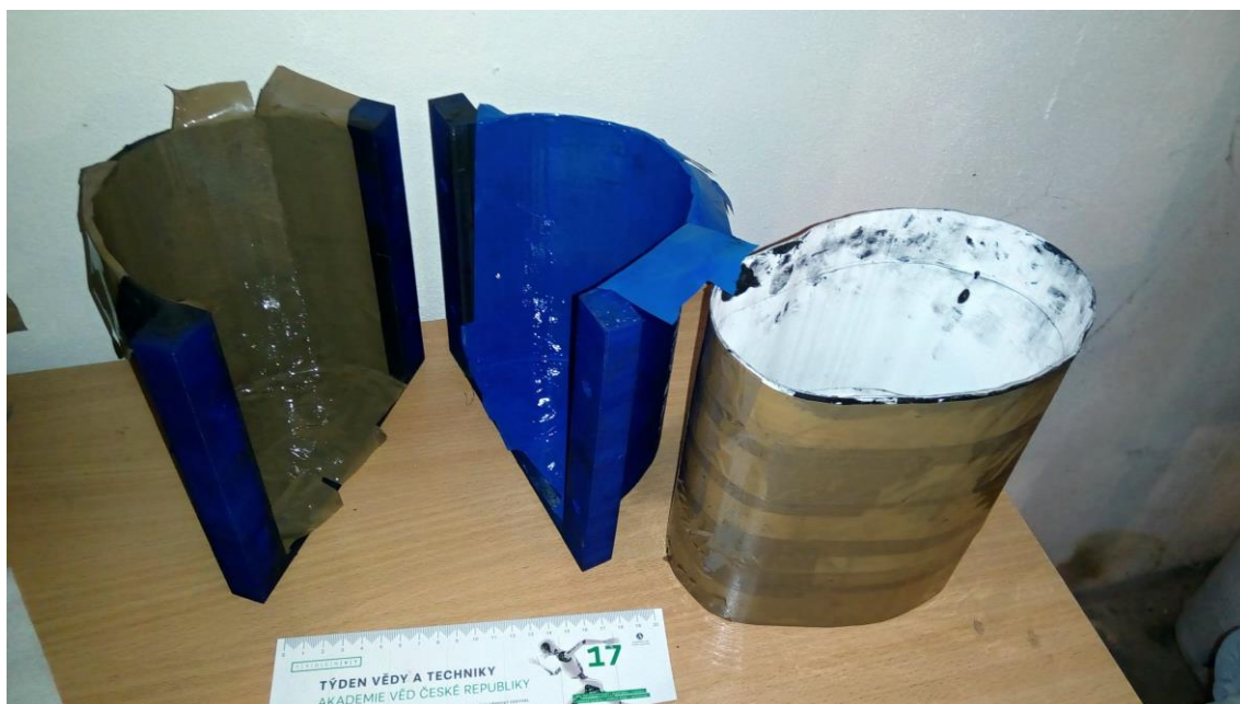
Obrázek 2.10: Formy připravené na nalití směsi. Tenká lesklá lepicí páska zabraňuje přilepení se směsi ke stěnám vytištěné formy.
