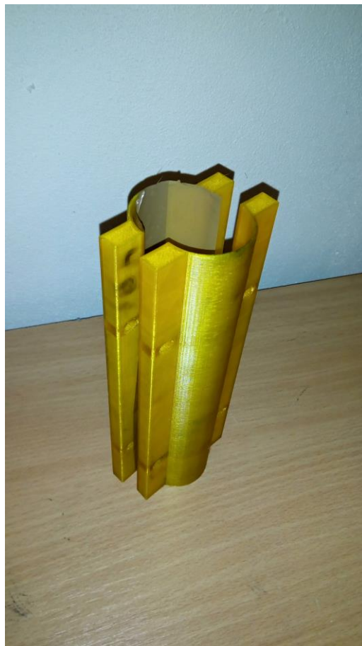
Obrázek 3.4: Vytisknutá forma pro odlévání fantomu cévní mozkové příhody.
