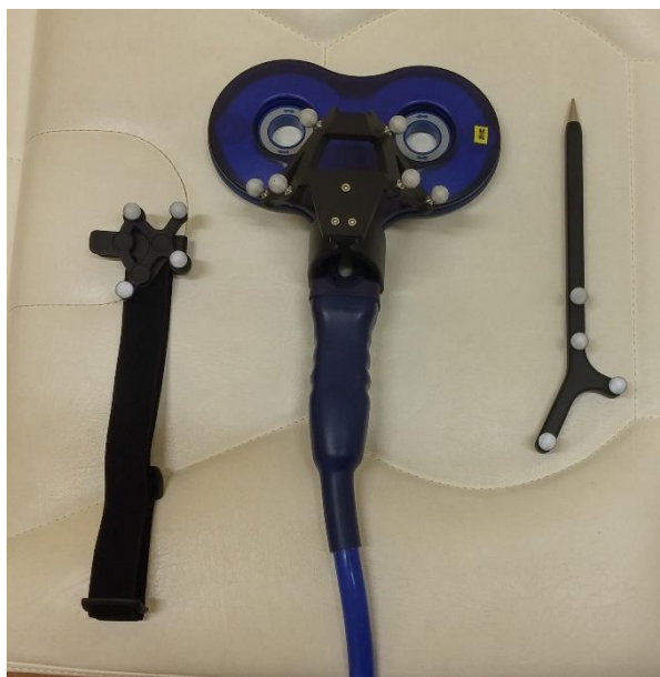
Obrázek 13: Navigační pomůcky Magstim D70mm Remote Control Coil, pero a pacientská čelenka (foto autor)
