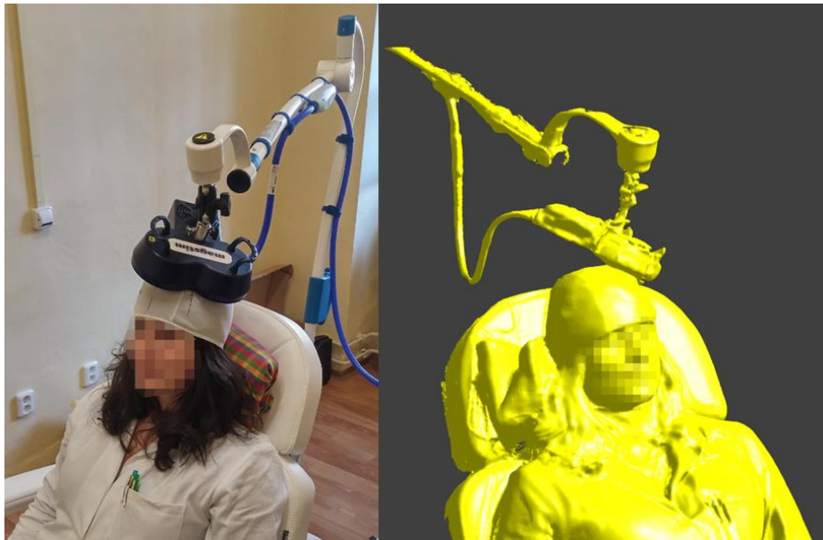
Obrázek 37: Ukázka trojrozměrného skenu pacienta s orientovanou cívkou rTMS [52]
