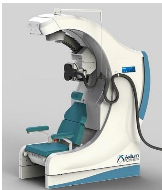
Obrázek 2: Robot pro rTMS Axilum Robotics [27]
