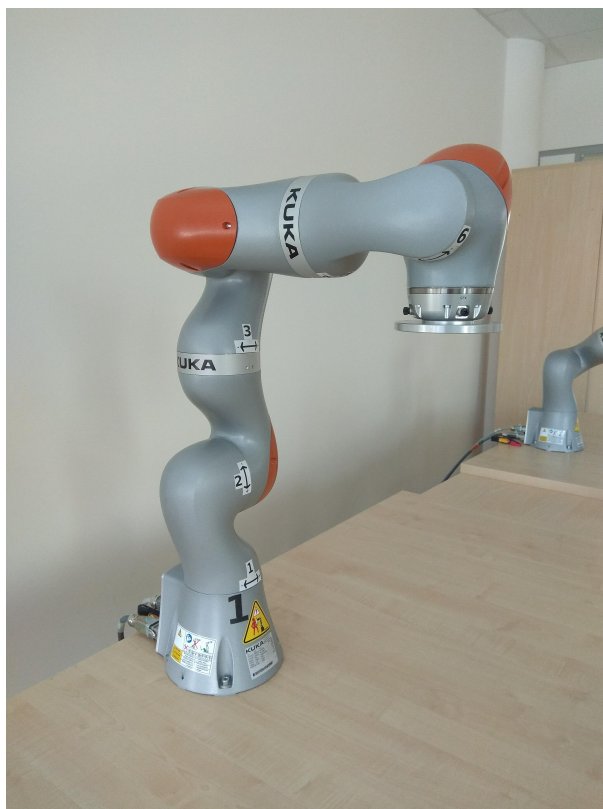
Obrázek 2.5: Robotické rameno KUKA LBR iiwa R800. Zdroj: M. Kmoníčková
