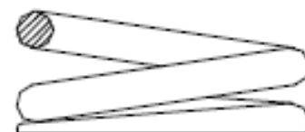
Obrázek 9: Zakočení závěrného závitu [4]
