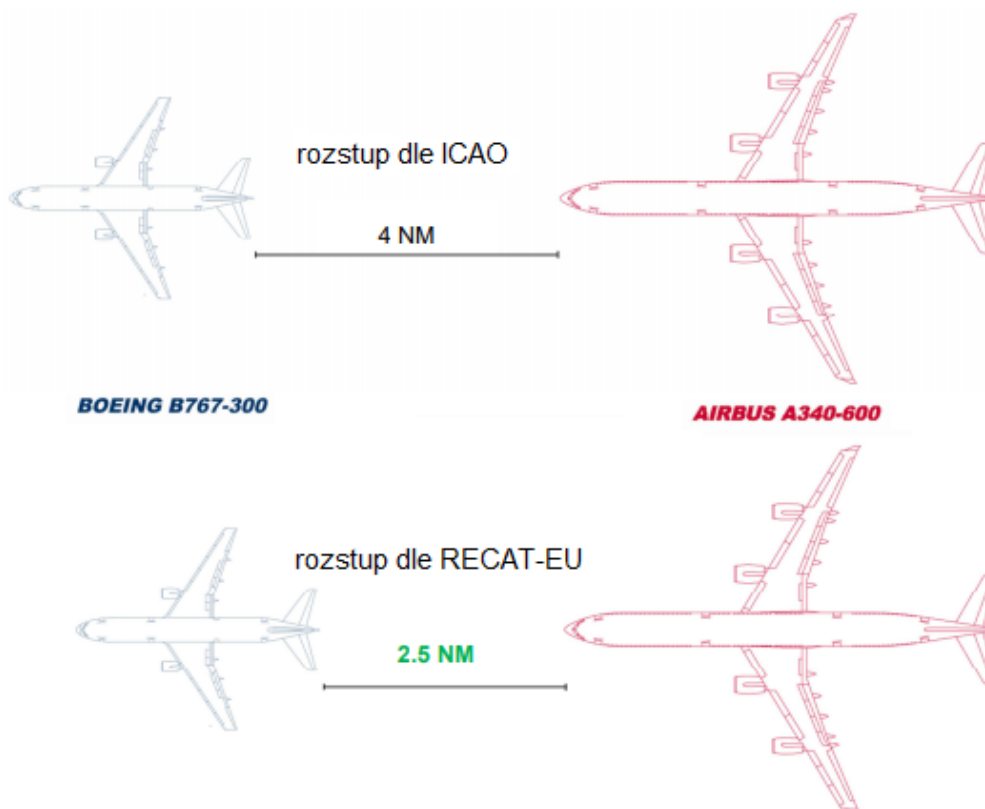
Obrázek 21: Změna rozstupů podle RECAT-EU mezi letouny, které oba spadají do kategorie HEAVY podle ICAO [2]
