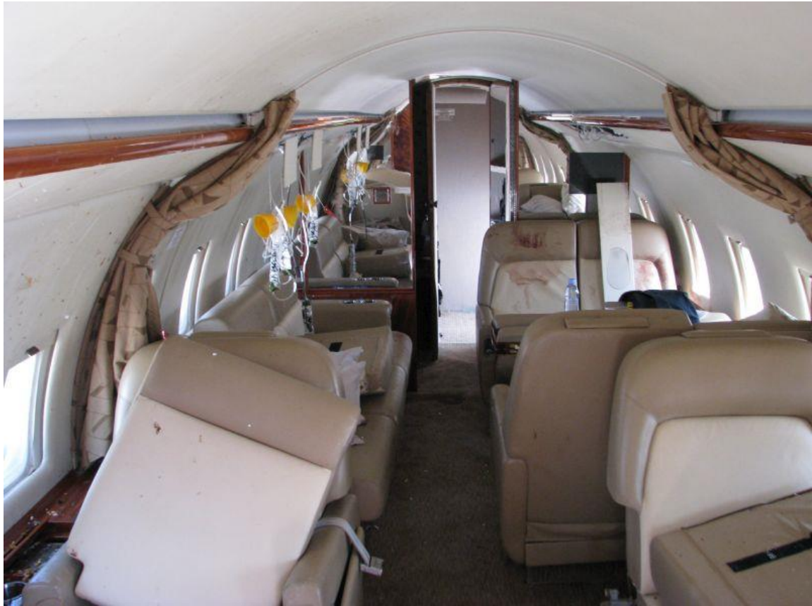
Obrázek 25: Vnitřní stav letadla po nehodě - poškození kabiny (pohled proti směru letu) [21]
