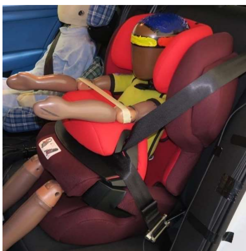
Obr. 5: DZS s bezpečnostním pultem Cybex Juno 2- fix (zdroj: fotodokumentace laboratoře ŠKODA AUTO)
