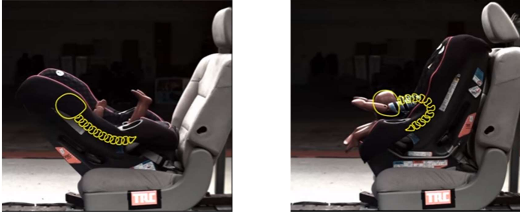
Obr. 3: Ohyb dětské páteře při nárazu v protisměrném DZS skupiny I (vlevo) a při přepravě po směru jízdy (vpravo) [43]
