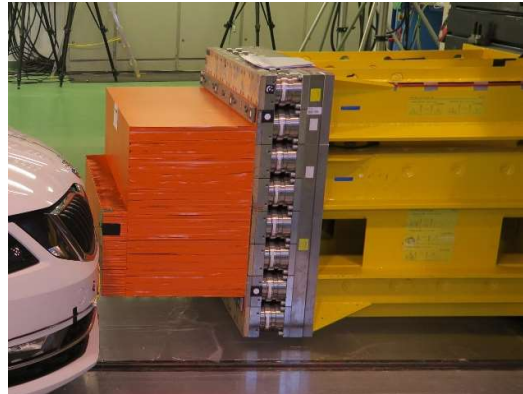
Obr. 72: Deformovatelná bariéra (zdroj: fotodokumentace laboratoře ŠKODA AUTO)
