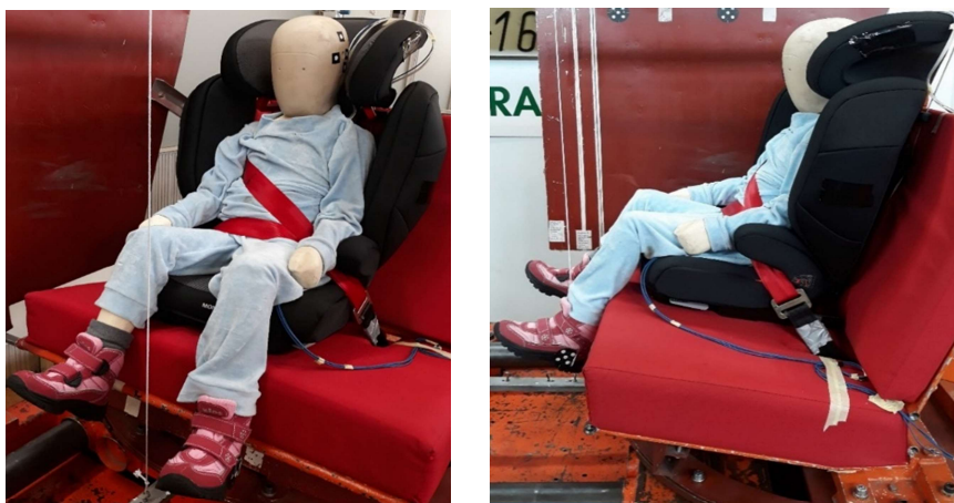
Obr. 42: Chybné vedení bezpečnostního pásu – test 2
