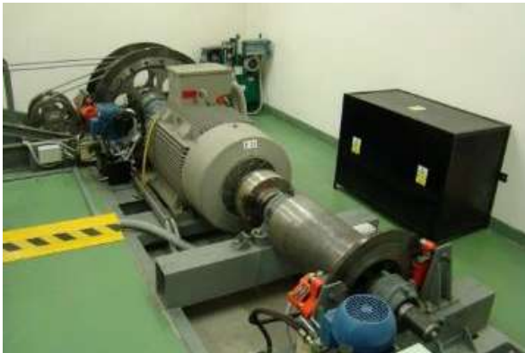
Obr. 71: Elektrická pohonná jednotka s lanovým pohonem se systémem Messring Microtrack [44]
