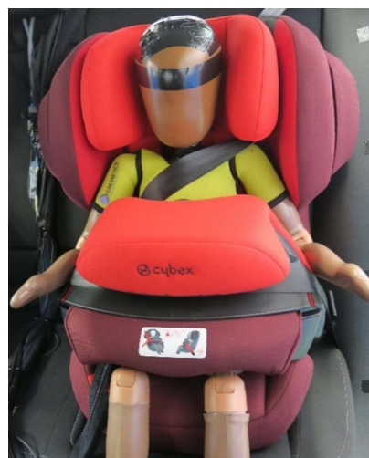
Obr. 6: Příklad chybného vedení diagonální části bezpečnostního pásu (zdroj: fotodokumentace laboratoře ŠKODA AUTO)
