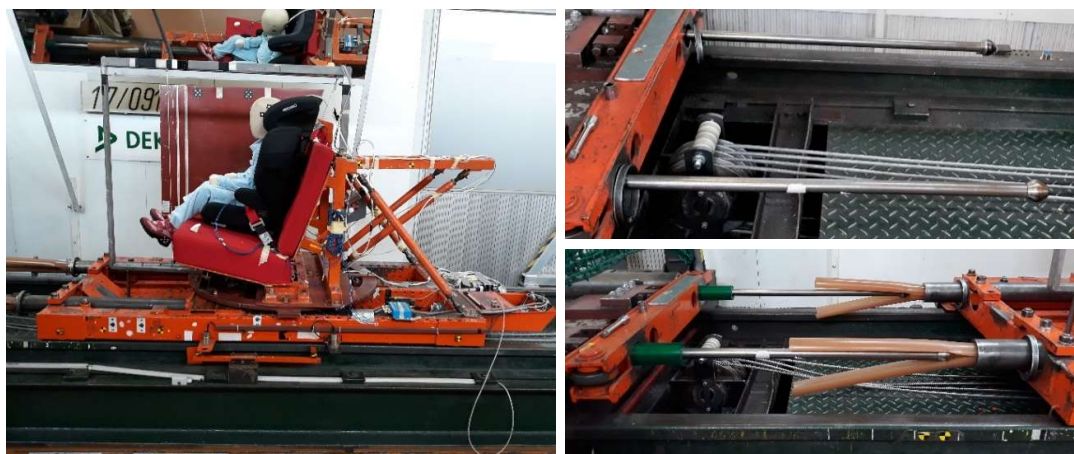
Obr. 23: Zkušební zařízení laboratoře: zkušební vozík osazený rámem vymežujícím roviny EHK 44 a zkušebním sedadlem (vlevo), ocelová konstrukce pro náraz s polyuretanovými výplněmi (vpravo)
