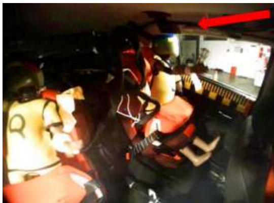
Obr. 7: Vypadnutí figuríny Q1 a Q3 z DZS během nárazové čelní zkoušky [9]
