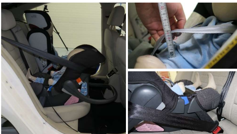
Obr. 67: Usazení figuríny P3/4 (zdroj: fotodokumentace laboratoře TÜV SÜD)
