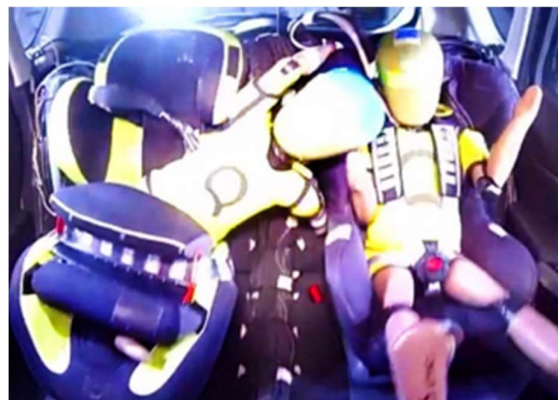
Obr. 8: Porovnání následků čelního nárazu mezi integrálním DZS a DZS s pultem [9]
