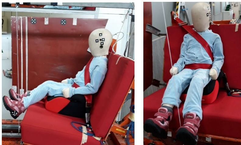
Obr. 52: Chybné vedení bezpečnostního pásu – test 1
