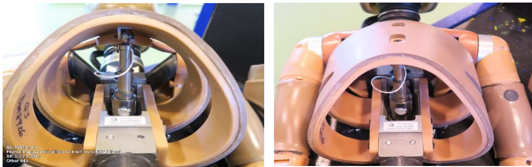
Obr. 21: Hrudní koš figuríny Q3 osazený snímačem IR-TRACC (zdroj: fotodokumentace laboratoře ŠKODA AUTO)
