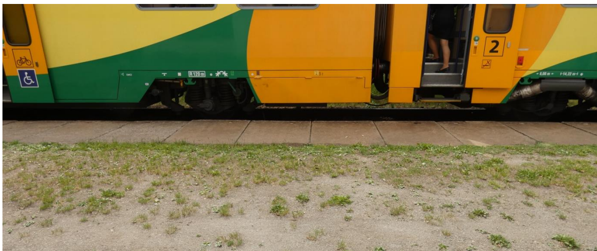
Obrázek 13: Ukázka výšky NH vzhledem k soupravě vlaku v zastávce Doubravník
