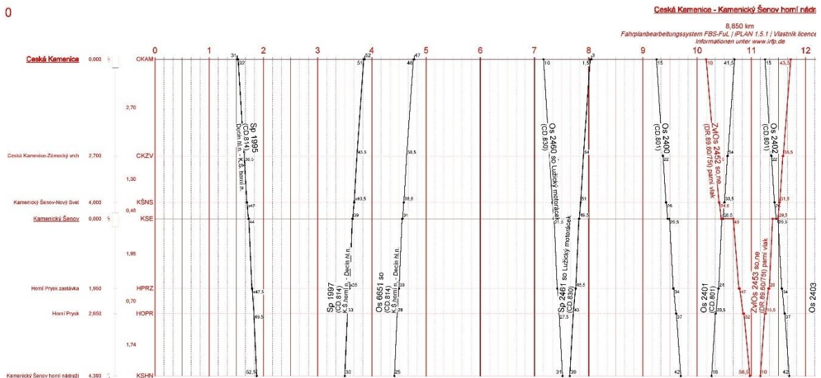
Obrázek 58 Výřez z nákresného jízdního řádu modelovaného provozního konceptu. Model byl vytvořen v softwaru FBS.
