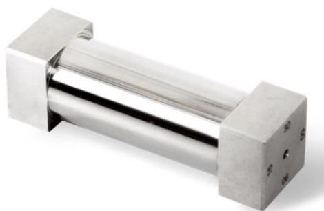
Obrázek 15: Natahovací pravítko TQC Baker film applicator [74]
