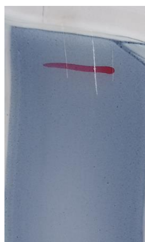
Obrázek 41: Provedený klínový řez, vzorek K2-LM na skle
