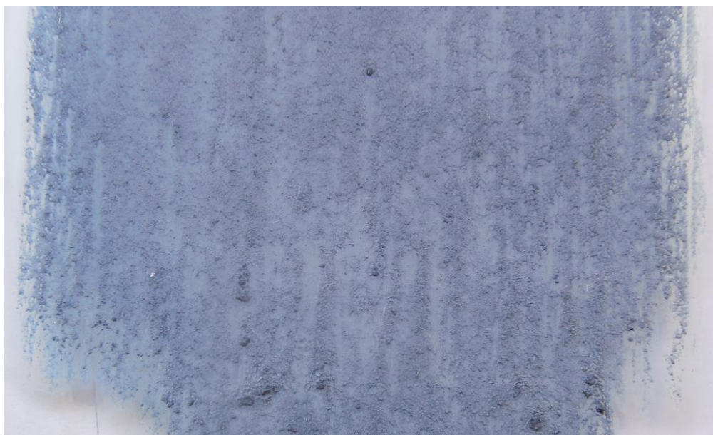
Obrázek 39: Hrubá neucelená textura povlaku s označením K3-RS
