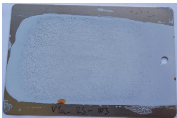
Obrázek 17: Korozní produkty a popraskání na vzorku K1-RS
