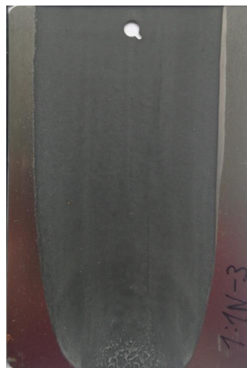
Obrázek 28: Praskliny v počátku nátěru u vzorku N1:1-LM na plechu
