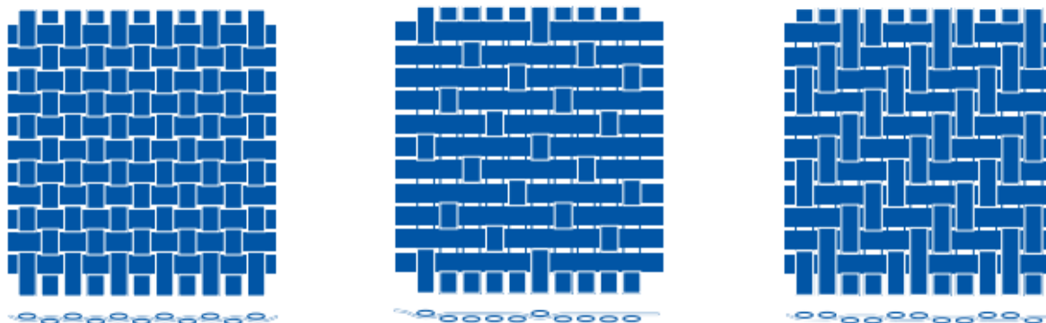
Obrázek 9 - Druhy vazeb; zleva: plátňová, saténová (atlasová) a keprová vazba [13]
