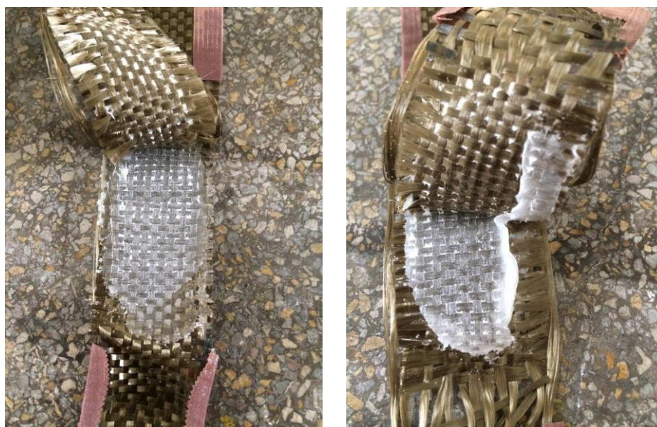
Obrázek 45 - Vzorek č. 1 (vlevo) a vzorek č. 5 (vpravo) po provedené T - zkoušce
