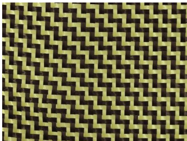
Obrázek 12 - Hybridní tkanina z uhlíkových a kevlarových vláken (keprová vazba) [14]
