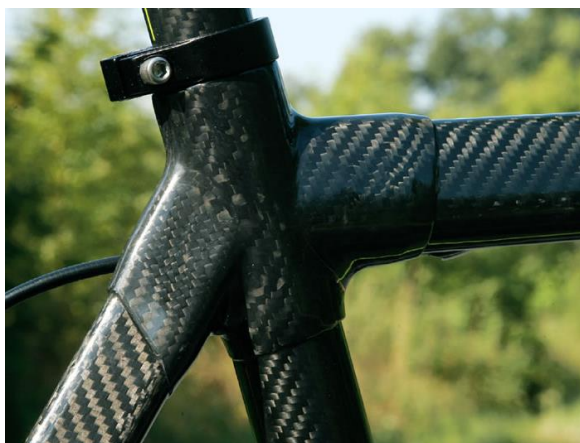
Obrázek 4 - Rám kola (vlevo) a helma (vpravo) z uhlíkového prepregu [7] [8]
