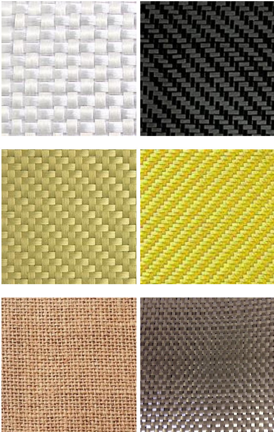
Obrázek 16 – Tkaniny z různých materiálů – zleva nahoře: skleněná tkanina (plátnová vazba) [18], uhlíková tkanina (keprová vazba) [14], aramidová tkanina (keprová vazba) [19], kevlarová tkanina (keprová vazba) [20], tkanina z juty (plátnová vazba) [21], čedičová tkanina (plátnová vazba)
