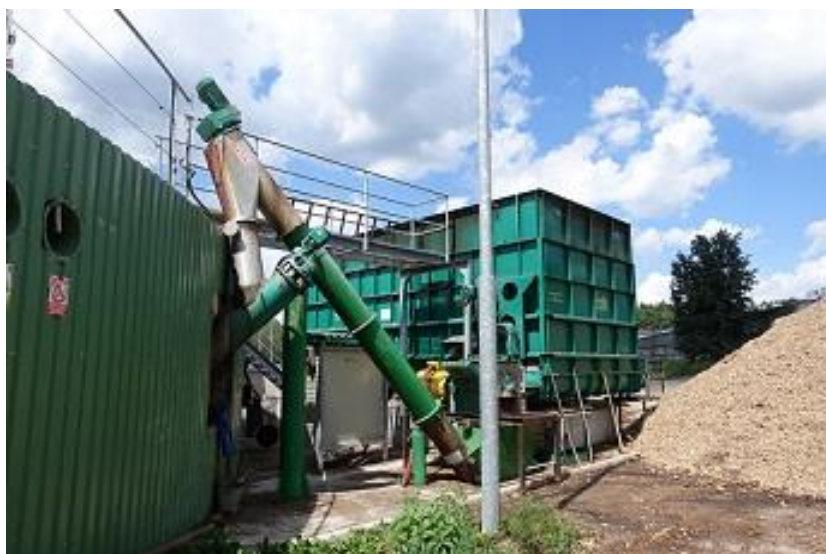
Obrázek 20 - Dopravníky v bioplynové stanici
