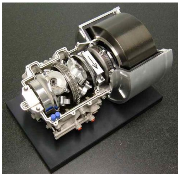
Obrázek 45 - Setrvačnický systém KERS s mechanickým variátorem [116]
