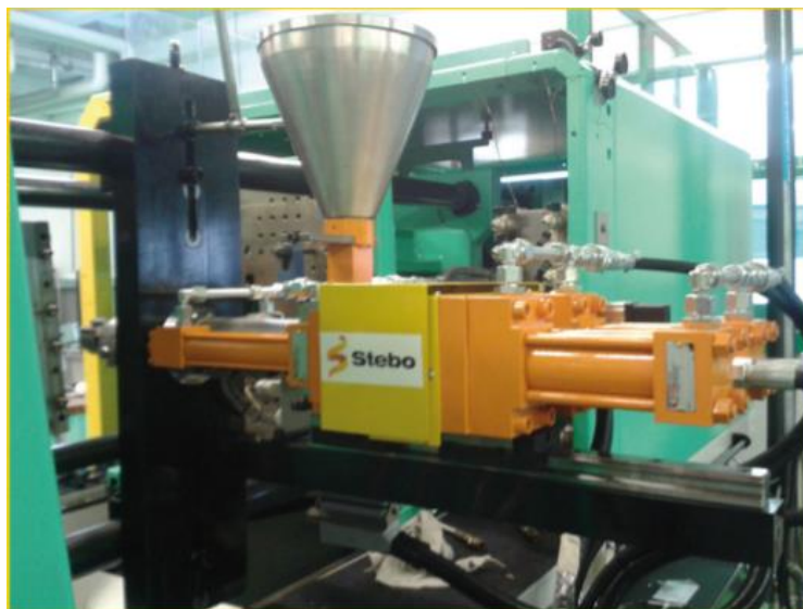
Obr. 30 Přídavná vstřikovací jednotka firmy Stebo [11]
