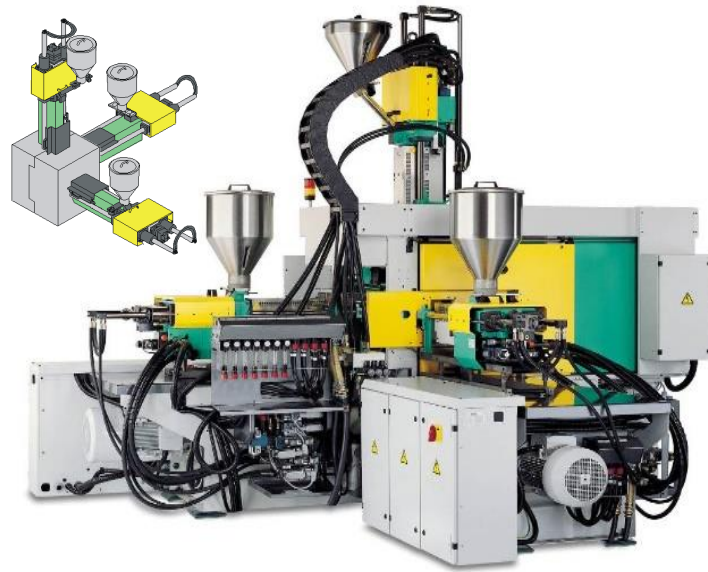
Obr. 6 Stroj pro trojkomponentní vstřikování [14]
