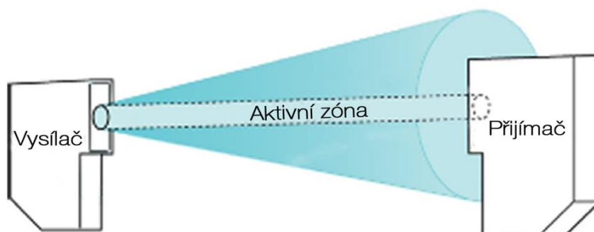
Obrázek 66: Princip optického snímače
