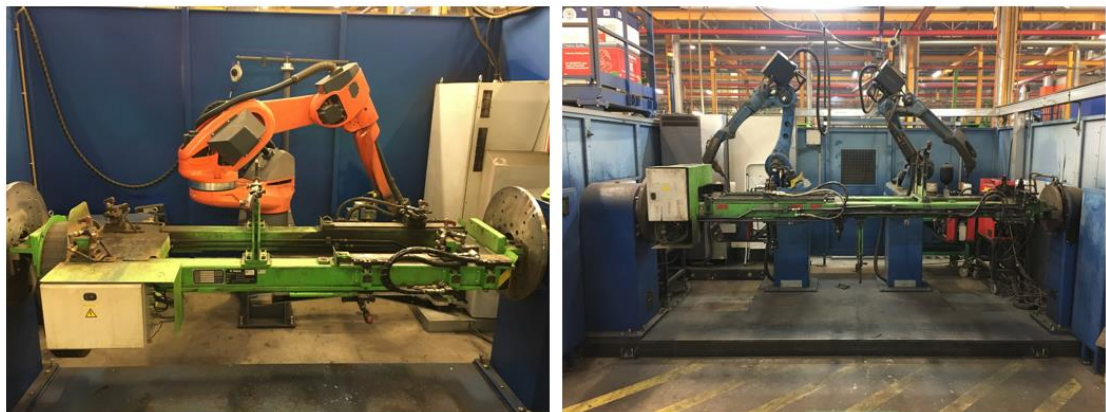
Obr. 39: Robotická stanoviště pro násady na levé straně robot Cloos včetně polohovacího přípravku a na pravé straně je vyfotografována dvojice robotů Yaskawa
