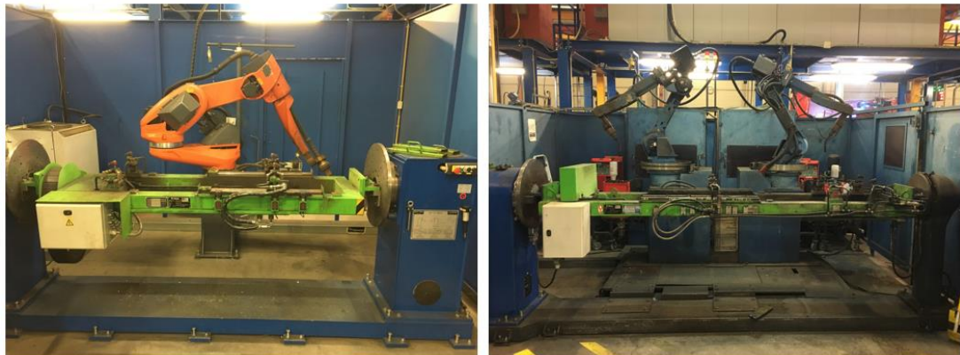
Obr. 47: Robotická stanoviště pro násady na levé straně robot Cloos včetně polohovacího přípravku a na pravé straně je vyfotografována dvojice robotů Yaskawa
