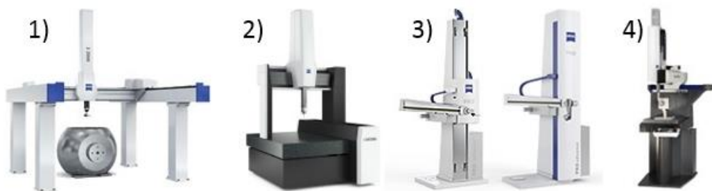
Obr. 31: Druhy souřadnicových měřících strojů: 1) Mostové CMM, 2) Portálové CMM, 3) Sloupové CMM s vodorovným ramenem, 4) Konzolové CMM [19]
