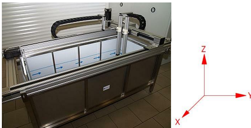
Obr. 4.1 - Souřadnicový manipulátor od Firmy INDETEC ndt
