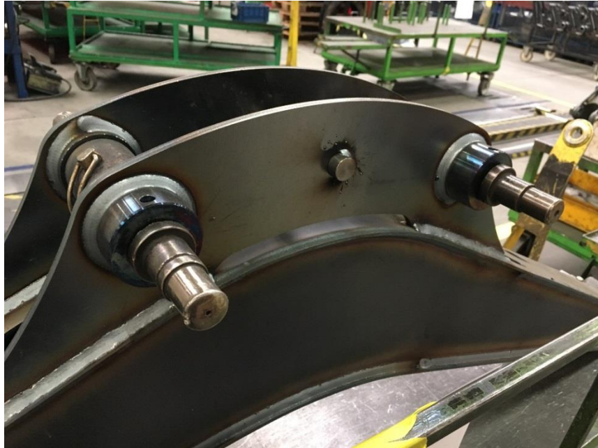
Obr. 31 –Rozperné valce s poistnými kolíkmi.
