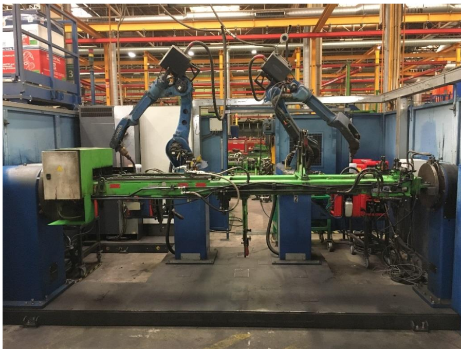
Obr. 34 – Pohľad na automatizovanú robotickú bunku.
