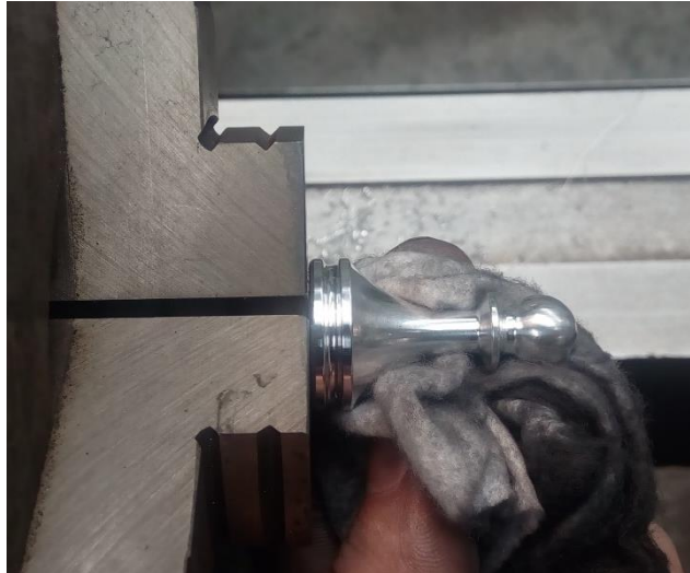
Obr. 133 Způsob leštění rotačních částí figurek
