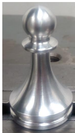
Obr. 32 Obrábění pěšce - druhý pokus optimalizace
