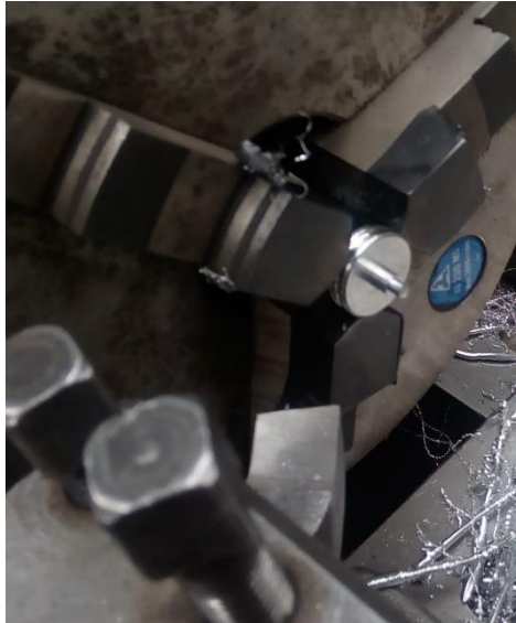
Obr. 135 Odstranění úpichu na figurece
