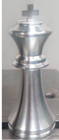
Obr. 108 Obrábění krále - první pokus optimalizace
