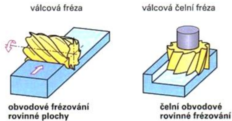
Obr. 8 Obvodové a čelní frézování rovinných ploch [29]
