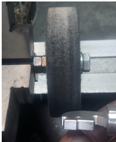
Obr. 134 Způsob leštění nerotačních částí figurek
