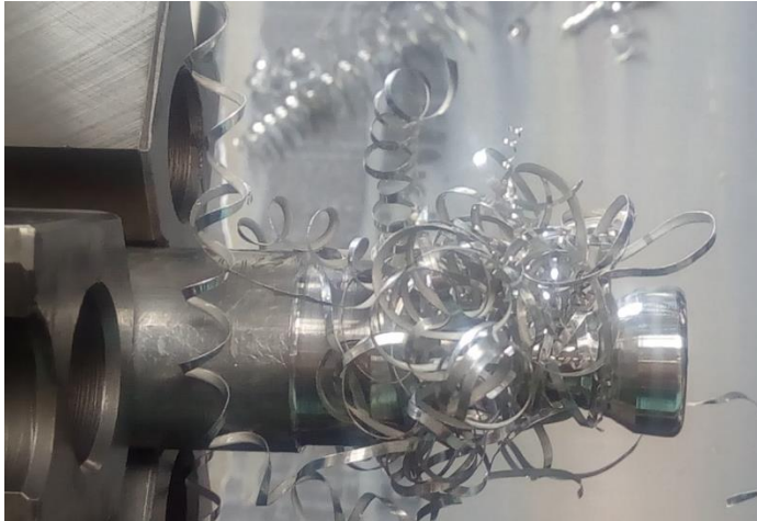
Obr. 49 Obrábění věže - první pokus optimalizace
