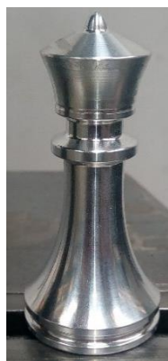
Obr. 68 Obrábění střelce - první pokus optimalizace
