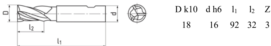
Obr. 19 Válcová čelní fréza 110418.180 [36]
