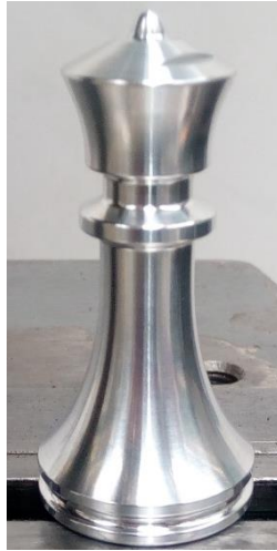
Obr. 74 Obrábění střelce - čtvrtý pokus optimalizace
