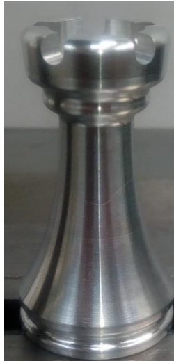
Obr. 50 Obrábění věže - druhý pokus optimalizace
