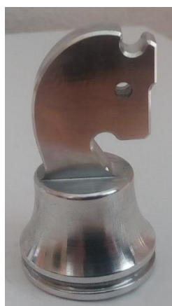
Obr. 131 Obrábění koně - druhý pokus optimalizace
