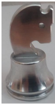
Obr. 132 Obrábění koně - třetí pokus optimalizace
