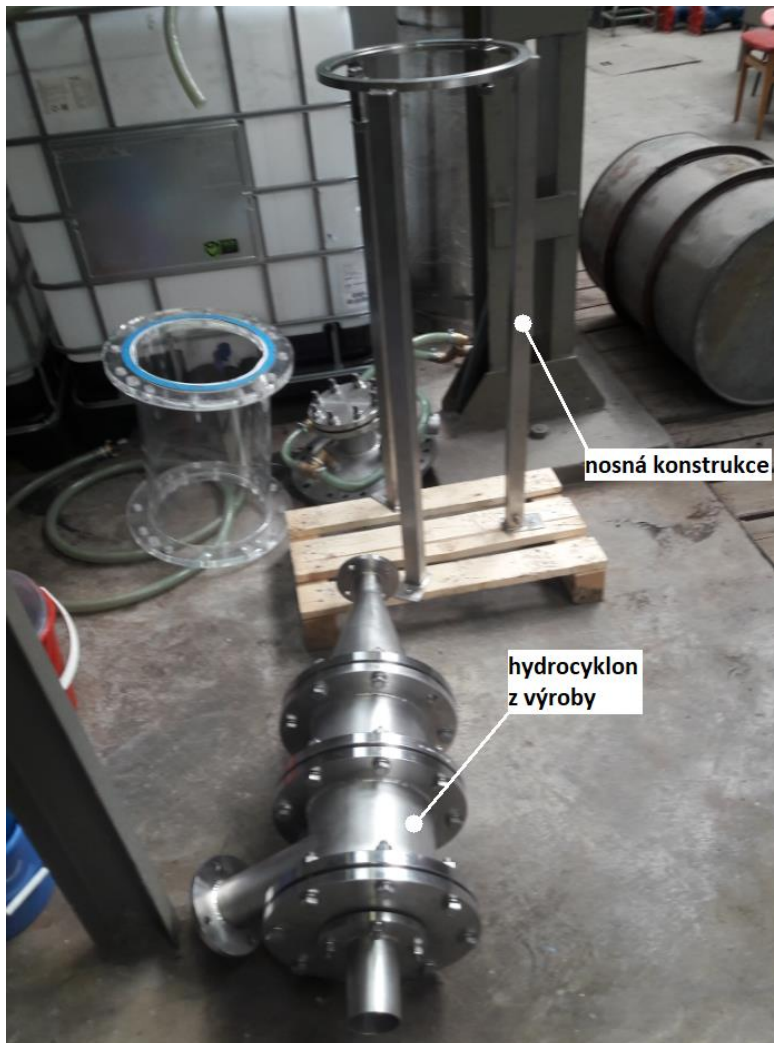
Obrázek 19: Fotografie z montáže laboratorního zařízení
