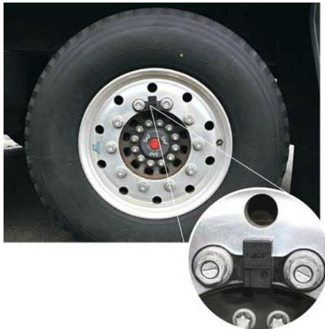
Obrázek 29: Připevnění senzoru stavu ložisek na disk kola [40]
