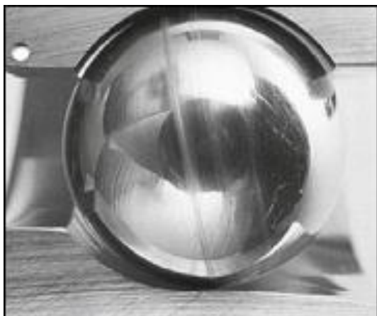
Obrázek 26: Valivý element ložiska poškozený odíráním [8]
