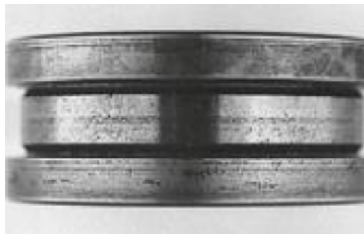
Obrázek 28: Vnitřní kroužek ložiska poškozený korozí [8]
