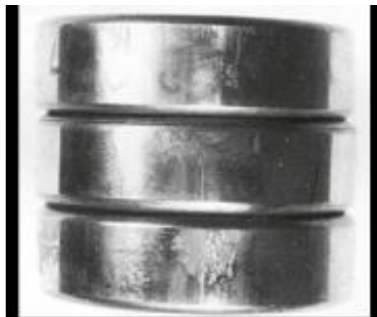
Obrázek 25: Vnější kroužek ložiska poškozený protočením v uložení [8]
