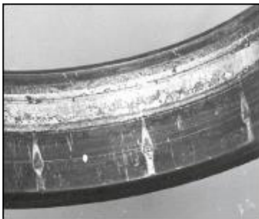
Obrázek 24: Prohlubeniny a otlaky způsobené nesprávnou montáží ložiska [8]
