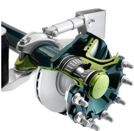
Obrázek 1: Uložení kola návěsové nápravy Valx, dvojice kuželíkových ložisek [30]
