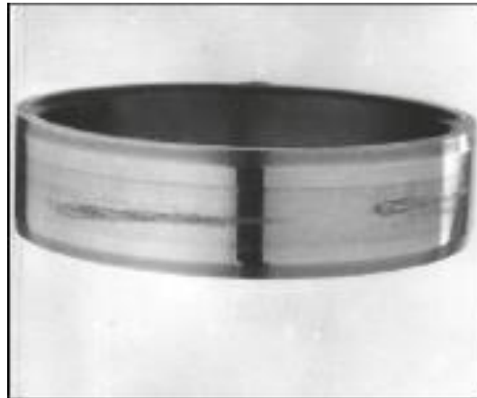
Obrázek 22: Odloupávání povrchu ložisek [8]
