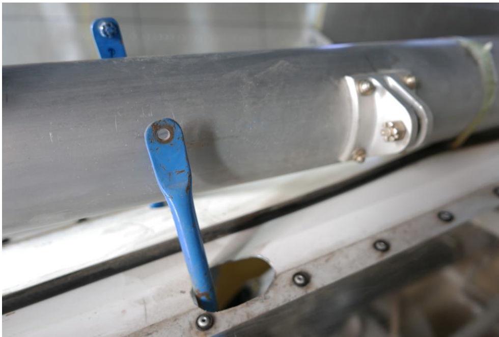
Obrázek 13: Zadní závěs křídla a páky řízení křidélek
