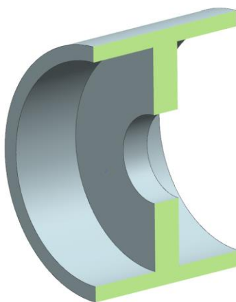
Obr. 15 Domeček silentbloku zobrazený v řezu
