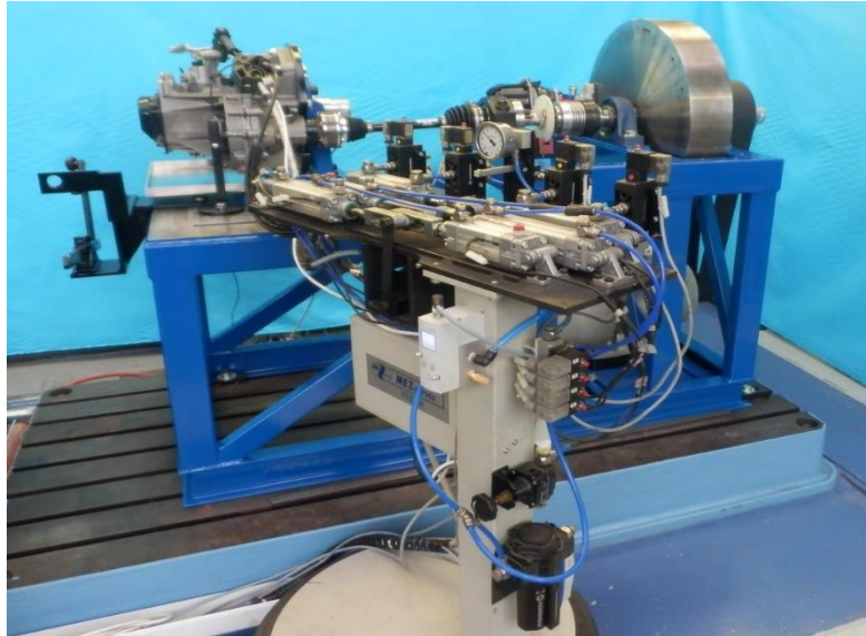
Obrázek 32: Setrvačnickový stav bez zakrytování hlavních částí [12]
