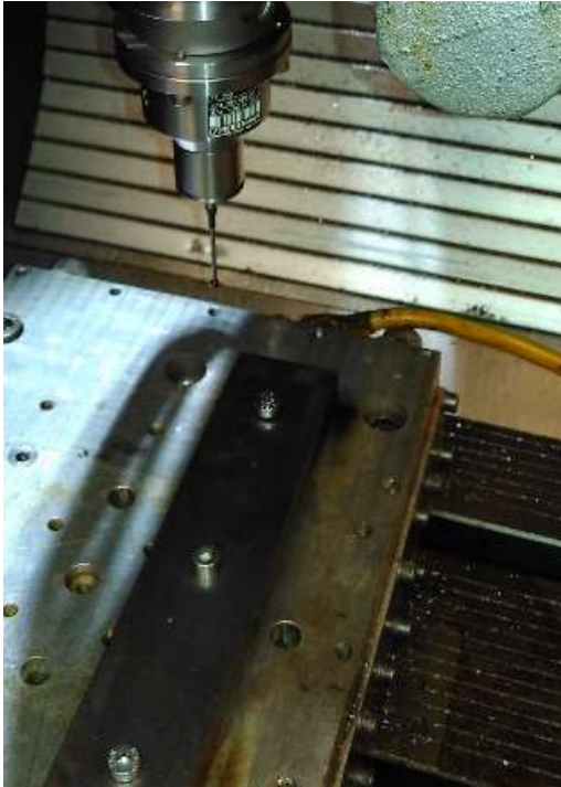
Obrázek 55 Měření polohy dotykovou sondou
