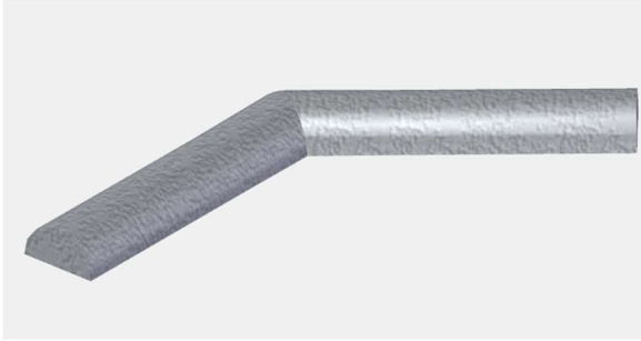
Obrázek 50 - při 120° je změna v rohu nepatrná
