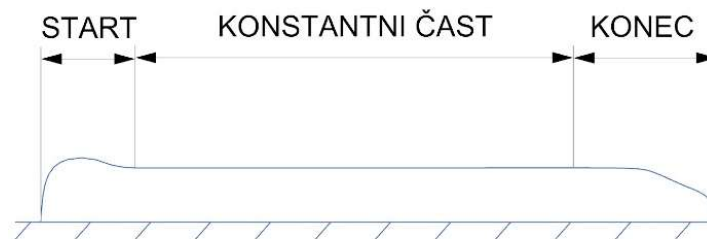
Obrázek 32 Oblast začátku a konce svarové housenky
