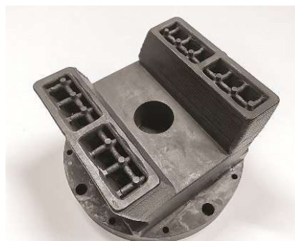
Dílec s vnitřní strukturou
