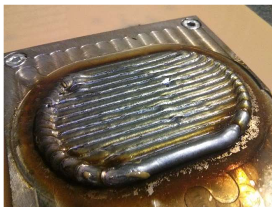
Obrázek 40 Metoda 4 - řádkování s konturou
