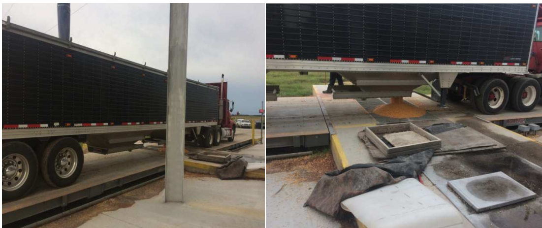
Obr. 3: Vyskladnění kukuřice z kamionu o objemu 80\text{m}^3 do malého příjmového koše, současně při vyprazdňování je kamion vážen
