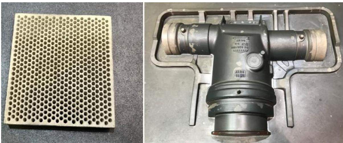
Obrázek 34 a 35 - Model a vtoková soustava - původní, filtr znázorněn vlevo
