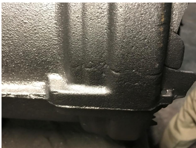
Obrázek 24 - Staženina na povrchu odlitku
