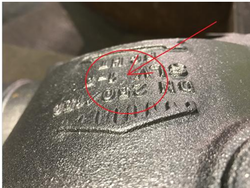
Obrázek 26 - Zborcení stěny odlitku - prohlubeň
