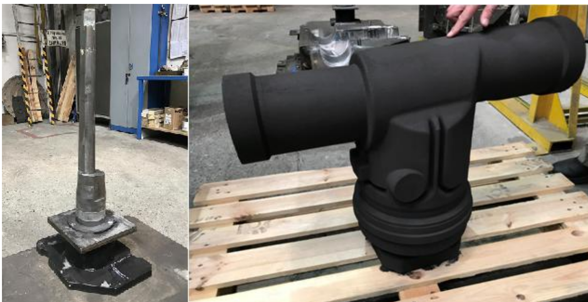
Obrázek 32 a 33 - Vlevo je výztuž jádra a vpravo je samotné jádro
