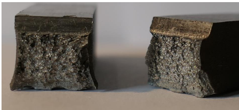
Obrázek 66 Lomová plocha vzorku V2
