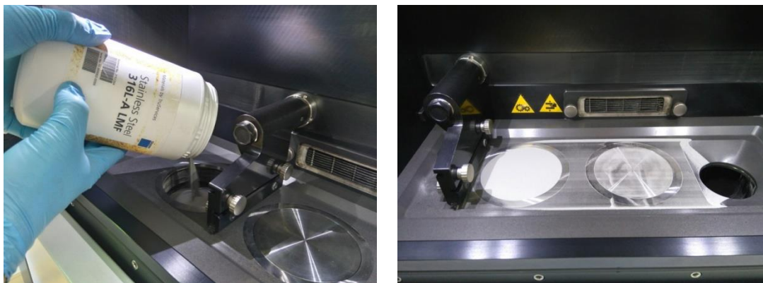
Obrázek 25 Plnění zásobovacího válce a plný válec s vyrovnanou pracovní paletou.
