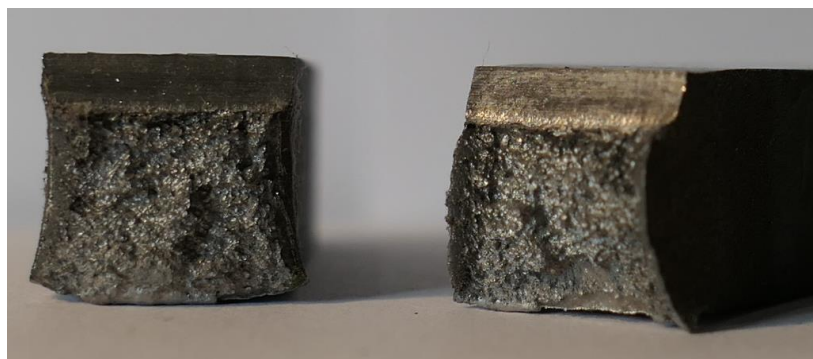
Obrázek 68 Lomová plocha vzorku V4
