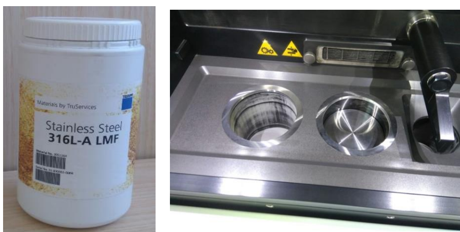
Obrázek 24 Zásobovací válec před dosypáním prášku
