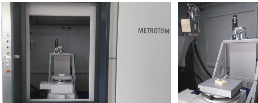
Obrázek 52 Vzorek v tomografu
